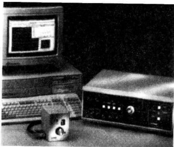
Рис. 1.1.25. Сканирующий туннельный микроскоп (STM).
