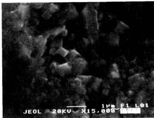
Рис. 3.4.10. Кубические кристаллы железа (Чеболакша, изображение во вторичнорассеянных электронах).
