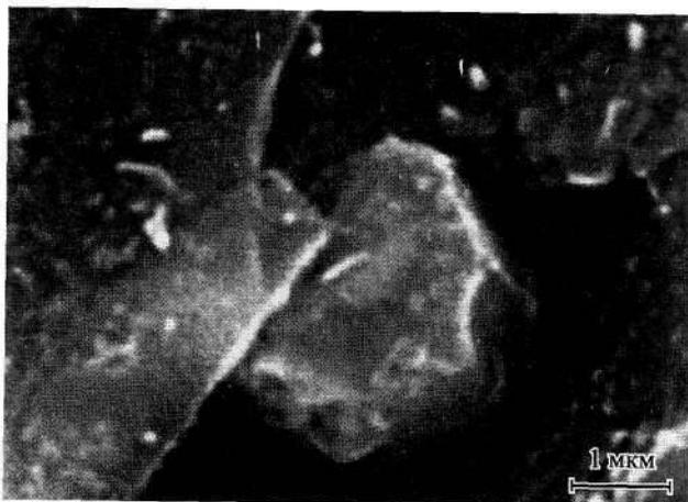
Рис. 3.1.4. Угловатое зерно иттриево-лантаноидного состава.
