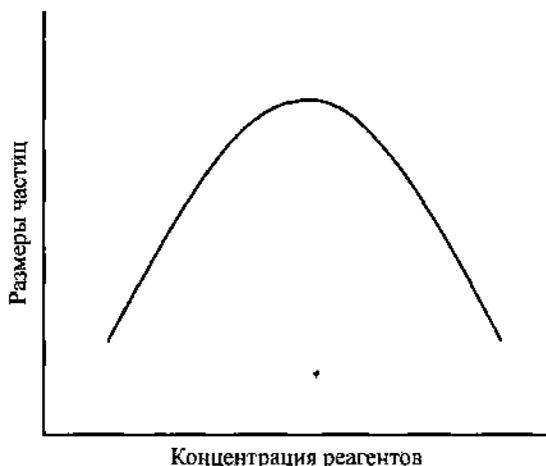
Рис. 4.2.5. Зависимость размеров частиц от концентрации исходных реагентов, по П. П. Веймарну (1906).
