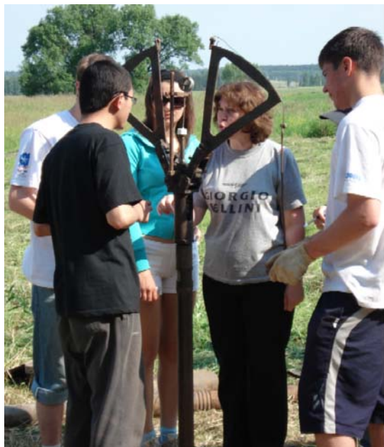
Доцент С.К. Николаева проводит со студентами определение деформационных свойств грунтов в скважине лопастным механическим прессиометром ЛПМ-15 конструкции Л.С. Амаряна, 2007 г.
