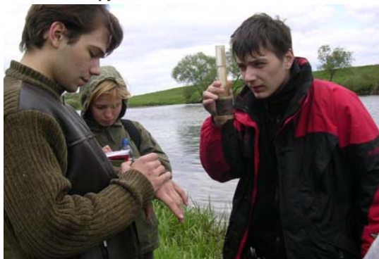
Студенты экогеологи определяют коэффициент фильтрации флювиогляциальных песков, Луцино, 2004 г.
