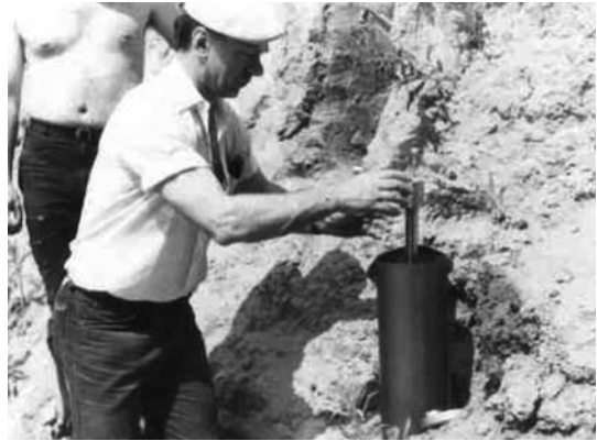
Профессор И. Осипов в маршруте ведет опробование свойств флювиогляциальных песков на приборе Ковалева, ЗБС, 1989 г.
