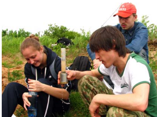
Определение коэффициента фильтрации трубкой Каменского
