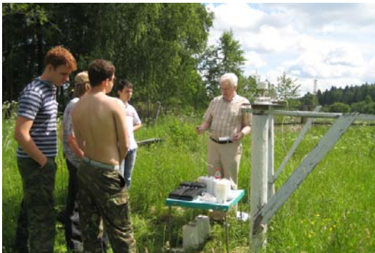
В.Д.Ершов проводит задачу по определению составляющих радиационно-теплового баланса
