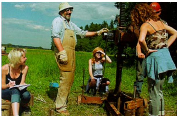
Е.Н. Добролюбов и Т.В. Андреева на занятии по статическому зондированию на установке УЗБ-5М-1 конструкции Л.С. Амаряна, ЗБС, 2002 г.
