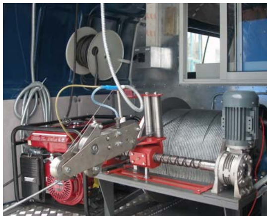
Фрагмент спуск-подъемного оборудования каротажной станции, использовавшейся на практике при проведении задачи стандартного каротажа в 1979-1989 гг.
