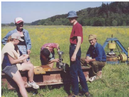
Определение сопротивления грунтов сдвигу на установке СУ-2 и приборе ВСВ-25
