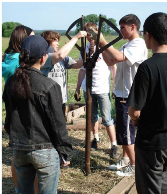
Доцент С.К. Николаева проводит со студентами определение деформационных свойств грунтов в скважине лопастным механическим прессиометром ЛПМ-15 конструкции Л.С. Амаряна, 2007 г.
