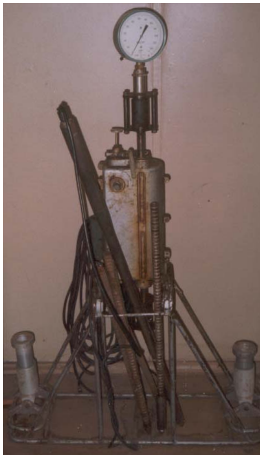
Ручная установка статического зондирования грунтов ПССЗ-2 с набором штанг и зонд «Пика-17»
