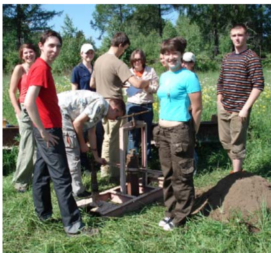
Определение деформационных свойств грунтов штамповой установкой УДПСШ-600 (сзади видна упорная балка), 2007 г.
