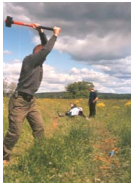
Инженер-геологи выполняют сейсмопрофилирование под руководством А.Ю.Калашникова, ЗБС, 2004 г.
