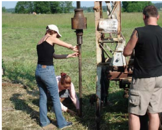
Динамическое зондирование грунтов на установке УБП-15М, 2007 г. (слева) и 2008 г. (справа)
