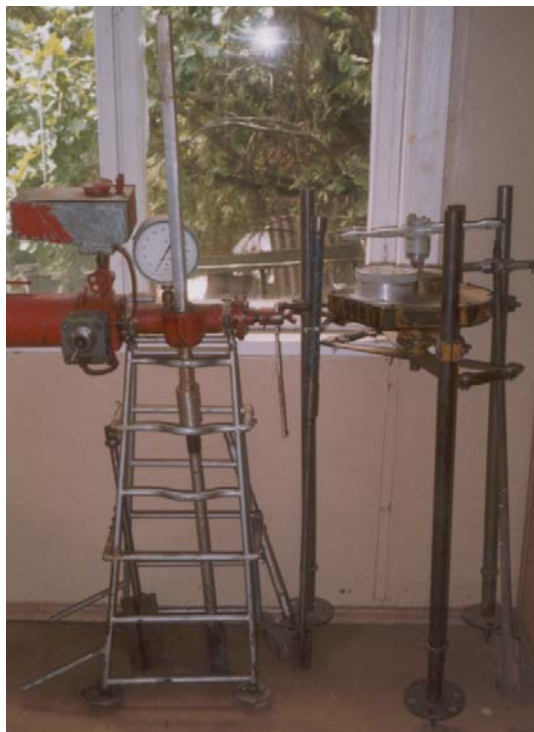
Первая крыльчатка (справа), применяемая на практике и крыльчатка с пневматическим приводом (слева)
