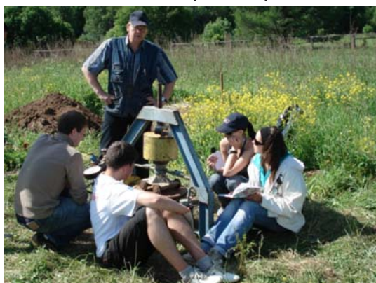
Доцент М.Б.Куринов проводит со студентами определение прочности грунтов крупногабаритной сдвиговой установкой СУ-2, 2007 г.
