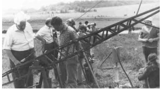
Профессор Г.С. Золотарев и А.Е. Крылов около штамповой установки для испытания грунтов пробными нагрузками, ЗБС, 1975 г.
