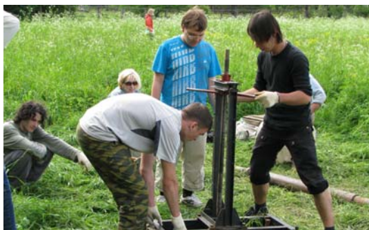
Доцент Т.И. Аверкина проводит задачу на малогабаритной установке статического зондирования конструкции Л.С.Амаряна, 2009 г.
