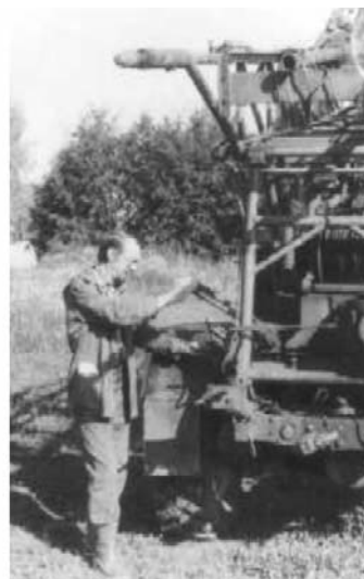
Ручная установка статического зондирования грунтов ПССЗ-2 с набором штанг и зонд «Пика-17»
