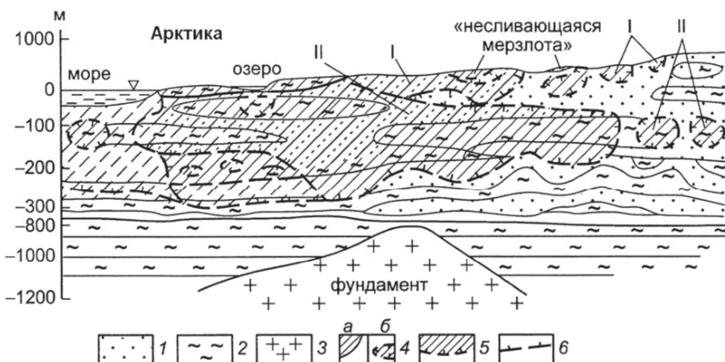
Рис. 4.11. Генетическая модель Арктического гидрогеологического бассейна криолитозоны (по материалам Н. Н. Романовского и др.):
