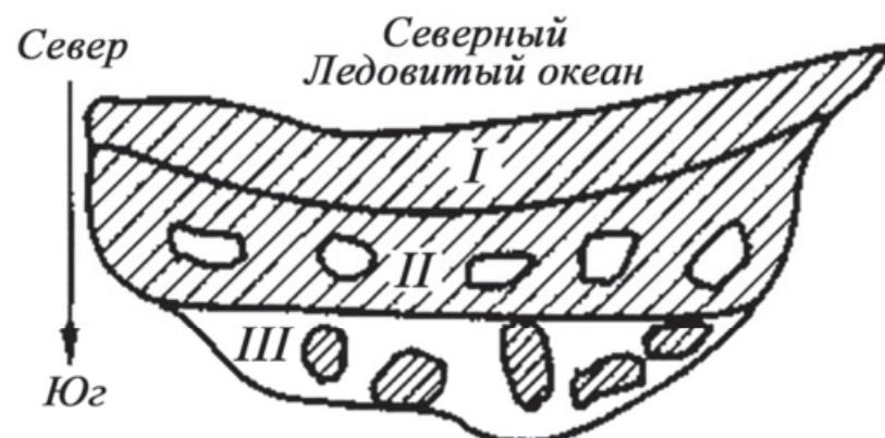
Рис. 4.12. Гидрологическая модель зональности ВМП бассейнов криозоны Арктики [https://studopedia.ru и др]: I – сплошная зона ВМП; II – зона с таликами; III – локальные зоны мерзлоты
