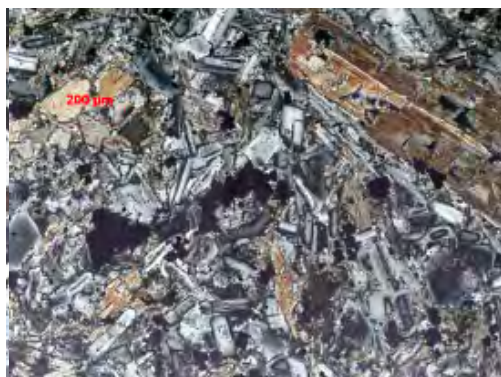
Р-4. Глубина 437,3 м. Николи «+». Бластодолерит. Новообразования актинолита среди реликтовой офитовой матрицы исходной породы
