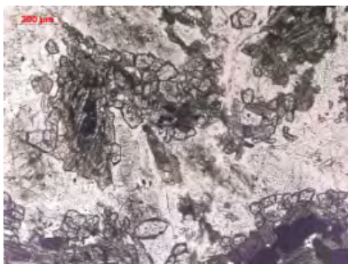
Р-4. Глубина 557 м. Николи «-». Гранат-роговообманковый матадолерит. Мелкозернистый агрегат граната приурочен к контактовым участкам роговой обманки и плагиоклаза
