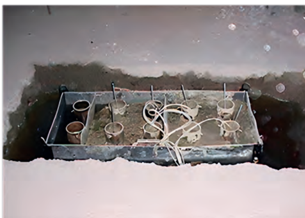
Рис. 4.33. Общий вид исследовательских установок для проведения натурных исследований миграции радионуклидов
