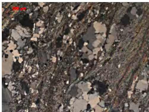
Р-1. Глубина 376,7 м. Николи «+». Серцитизированный биотитовый плагиогнейс. Бластомилонитовая структура. Новообразования серицита и сотового кварца
