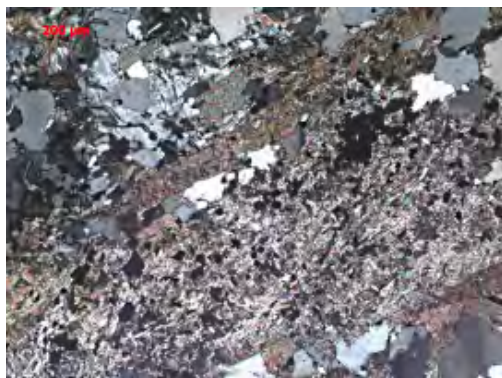
Р-1. Глубина 420,5 м. Николи «+». Грейзенизированный биотитовый гнейс. Спутано-лепидобластовый агрегат новообразований тонкочешуйчатого мусковита субпараллельный первичной гнейсовидности
