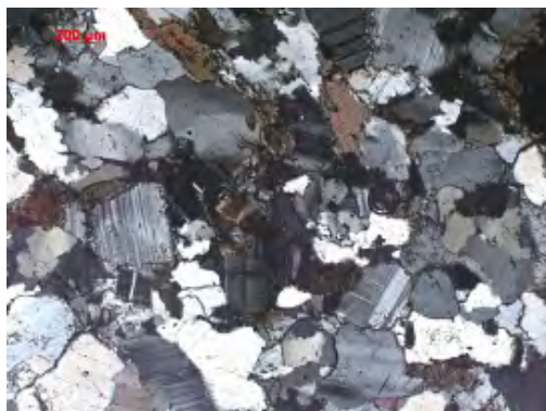
Р-1. Глубина 474,7 м. Николи «+». Биотитовый плагиогнейс. Незначительно проявленный межзерновой катаклаз, осложняющий первичную гранобластовую структуру породы. Кварц подвержен пластическим деформациям, а плагиоклаз механическому двойникованию. Биотит рутилизирован
