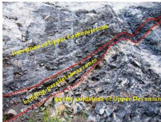
Рис. 21. Полевая фотография напластованно-параллельной сдвиговой зоны между известняками и кварцевыми песчаниками месторождения Синьцяо.
