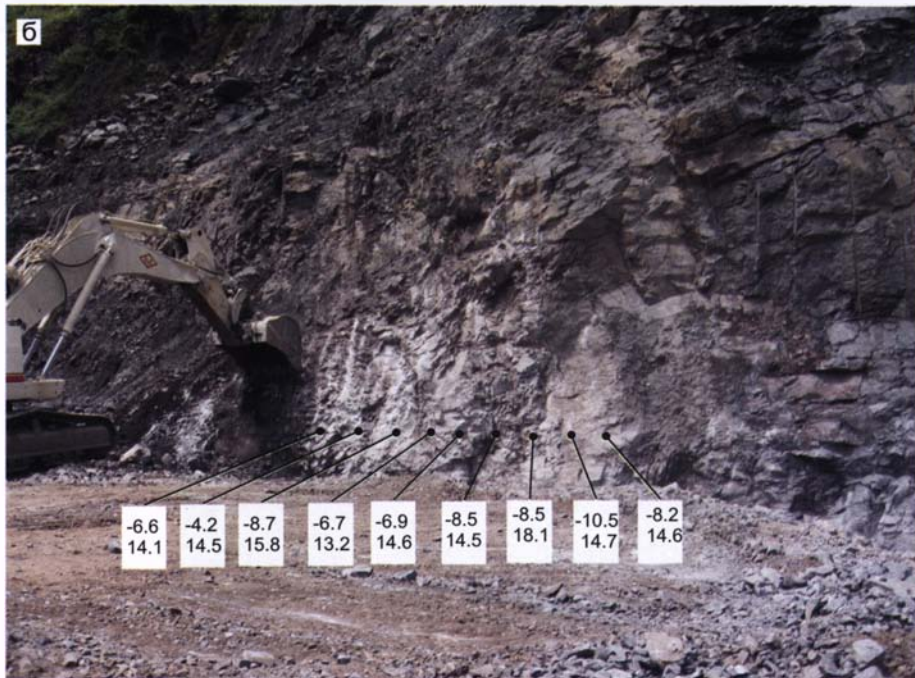
Фиг. 8.13. Общий вид карьера D (а) и место отбора проб на изотопный анализ (б) (верхняя цифра – изотопный состав углерода, \delta^{13}\text{C} , ‰; нижняя цифра – изотопный состав кислорода, \delta^{18}\text{O} , ‰).
