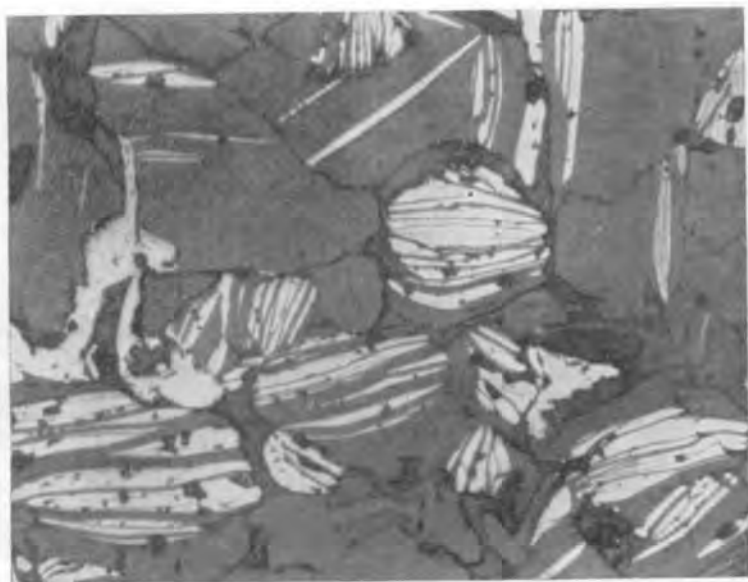
Рис. 9. Скопления магнетита 2 (белое) среди нерудных минералов (темно-серое). Апплиф, при одном никеле, увел. 200.
