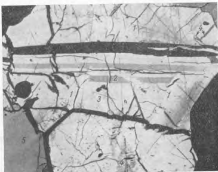
Рис. 4. Пластинчатые выделения пентландита (1) и кубанита (2) среди халькопирита (3). Апплиф, при одном никеле, увел. 200.
