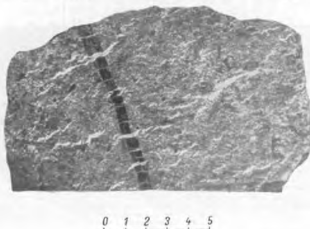
Рис. 2. Серия секущих халькопиритовых прожилков (белое) выполняет трещины разрыва в богатой вкрапленной сульфидной медно-никелевой руде в серпентините.
