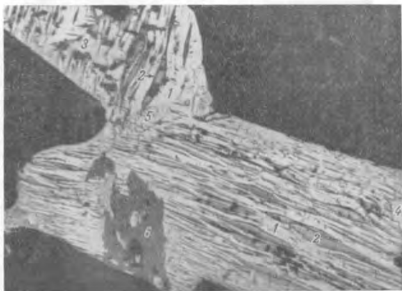
Рис. 13. Полосчатые гематит-марказитовые агрегаты в сильно измененной вкрапленной руде. Ашлиф, при одном никеле, увел. 220.
