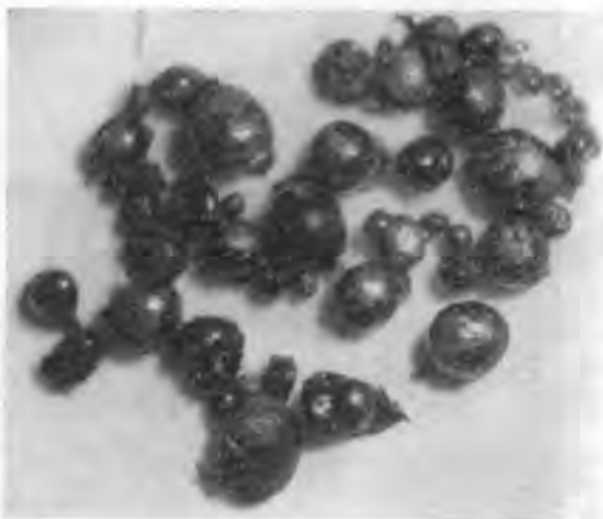
Рис. 2. Шарики самородного железа из искусственного шлифа амфиболовых гранодиоритов. Увел. 15.
