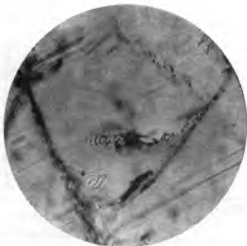
Рис. 5. Выделения гематита (черный) и опаловидной фазы (светлая между гематитом) в отожженном нефелине. Без анализатора, увел. 200.
