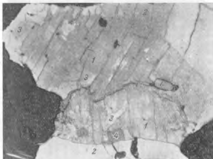
Рис. 2. Сиреневый пирротин (1) среди обычного пирротина 1 (2). Аншлиф, при одном никеле, увел. 220.
