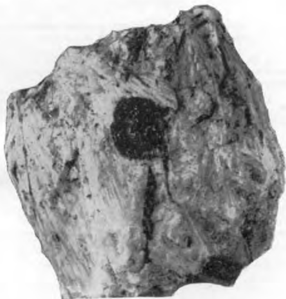
Сферическое образование сподиофиллита в натролите.
