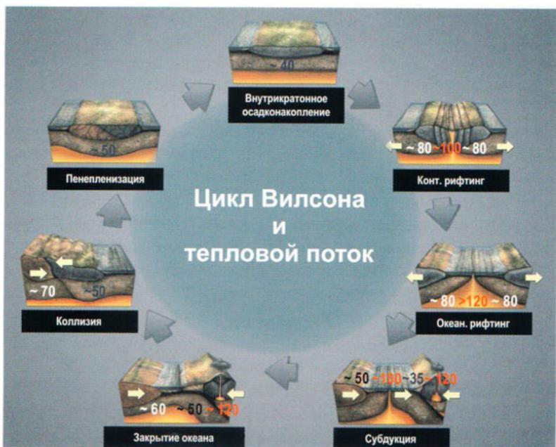
Рисунок 3.3. Геодинамические процессы и связь с плотностью теплового потока.
