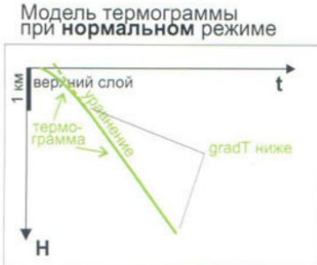
Рисунок 3.6. Идеальная модель термограммы при аномальном и нормальном геотермических режимах
