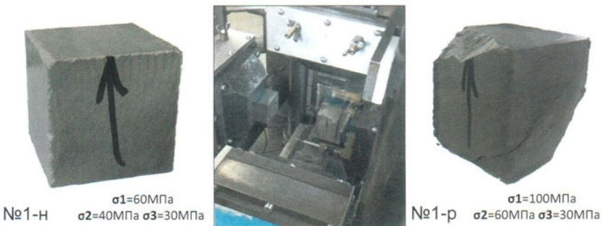
**Рисунок 4.24.** Образцы после нагружения в ИСТНН
