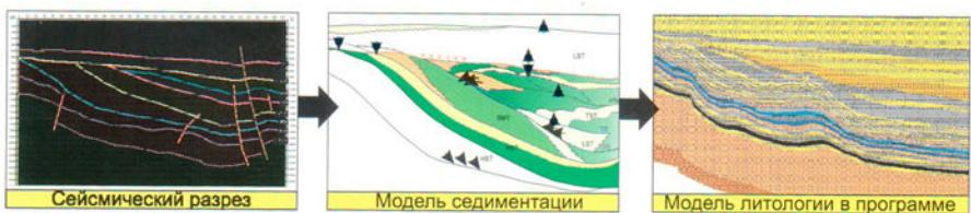
Рисунок 2.4. Принципиальная схема прогноза коллекторов и покрышек для бассейнового моделирования по данным сейсмостратиграфического анализа.
