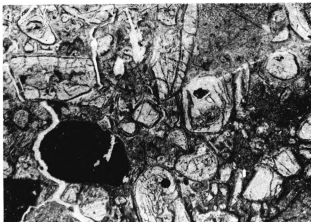
Рис. 23. Мелкообломочный кимберлитовый туф (брекчия) Неправильные зерна серпентинизированного оливина и обломки известняка в связующей массе; слева зерно ильменита \times 70 . Ник. ||
