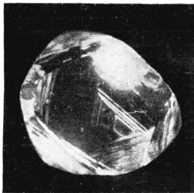
Рис. 117. Крупная и глубокая обратнопараллельная треугольная впадина со ступенчатыми стенками на грани кристалла алмаза. \times 13
