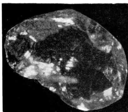
Рис. 185. Округлый ромбододекаэдр алмаза, удлинненный по оси симметрии четвертого порядка. \times 33
