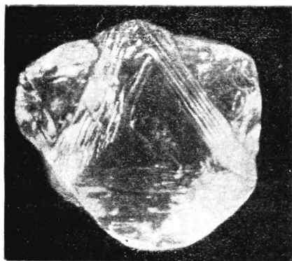
Рис. 104. Уплощенный шпинелевый двойник ламинарных октаэдров алмаза. \times 35
