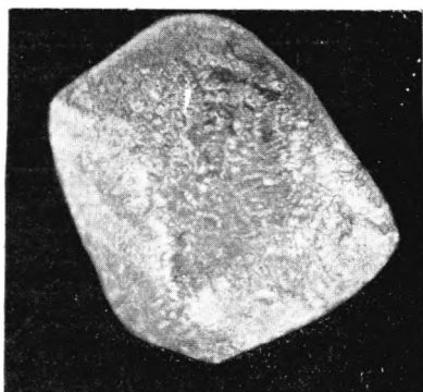
Рис. 135. Кристалл алмаза ромбододекаэдрического габитуса с грубокорродированной поверхностью и закругленными ребрами. \times 12
