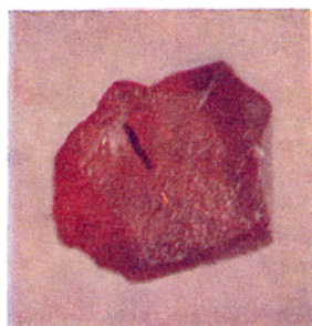
Рис. 52. Удлиненное игольчатое включение в оранжевом пиропе трубки «Мир». \times 30
