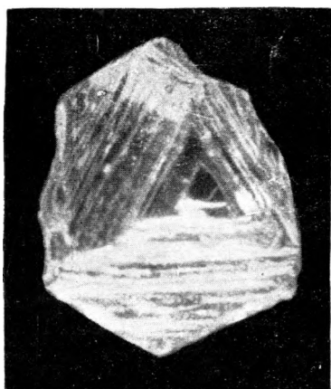
Рис. 89. Пластинчатый кристалл алмаза переходного габитуса от октаэдрического к ромбододекаэдрическому. \times 24
