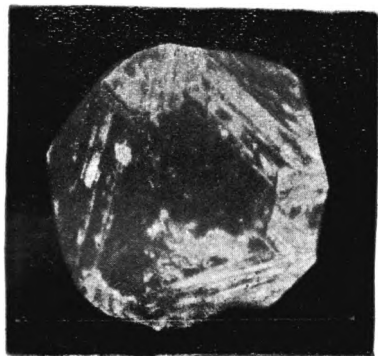
Рис. 124. Тетрагональные впадины на вершинах октаэдра алмаза. \times 23
