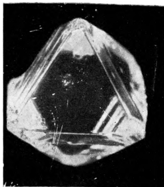
Рис. 141. Мелкие включения прозрачного минерала (циркона?) в октаэдре алмаза (в центре и вверху снимка). \times 6
