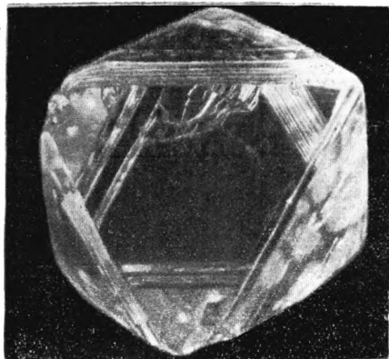
Рис. 149. Октаэдр алмаза с небольшим сколом на грани (у ребра). \times 7
