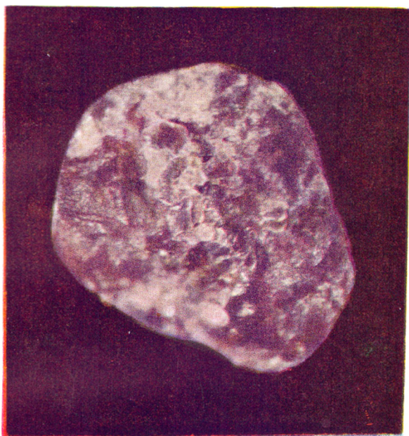
Рис. 71. Развитие чешуек флогопита по трещинам в зерне пироба из кимберлитовой трубки «Загадочная». \times 30
