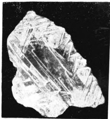
Рис. 165. Неправильно развитый (удлинённый по g_1 ) «гребенчатый» октаэдр алмаза. × 12
