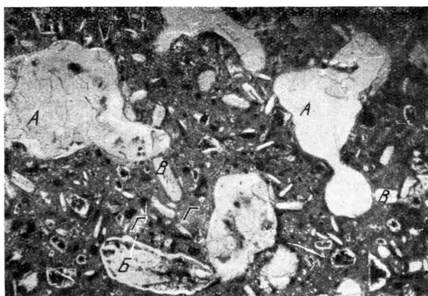
Рис. 17. Миндалекаменный измененный слюдой кимберлит из обломка в брекчии А — миндалины, выполненные серпентином и карбонатом; Б — псевдоморфозы серпентина и магнетита по оливину; В — листочки флогопита; Г — разложившаяся основная масса. \times 18 . Ник. ||
