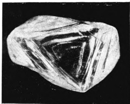
Рис. 173. Неправильно развитый октаэдр алмаза с округлоступенчатыми гранями. \times 28
