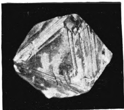
Рис. 128. Ламинарный октаэдр алмаза с пятнистой структурной матировкой на гранях. \times 17
