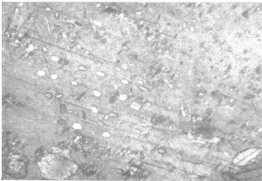
Табл. XXIV. Включения мелких кристаллов клинопироксена в плагиоклазе из ортомагматического габбро-норита. Шлиф 406а (р. Лозовика), с анализатором, увел. 250.
