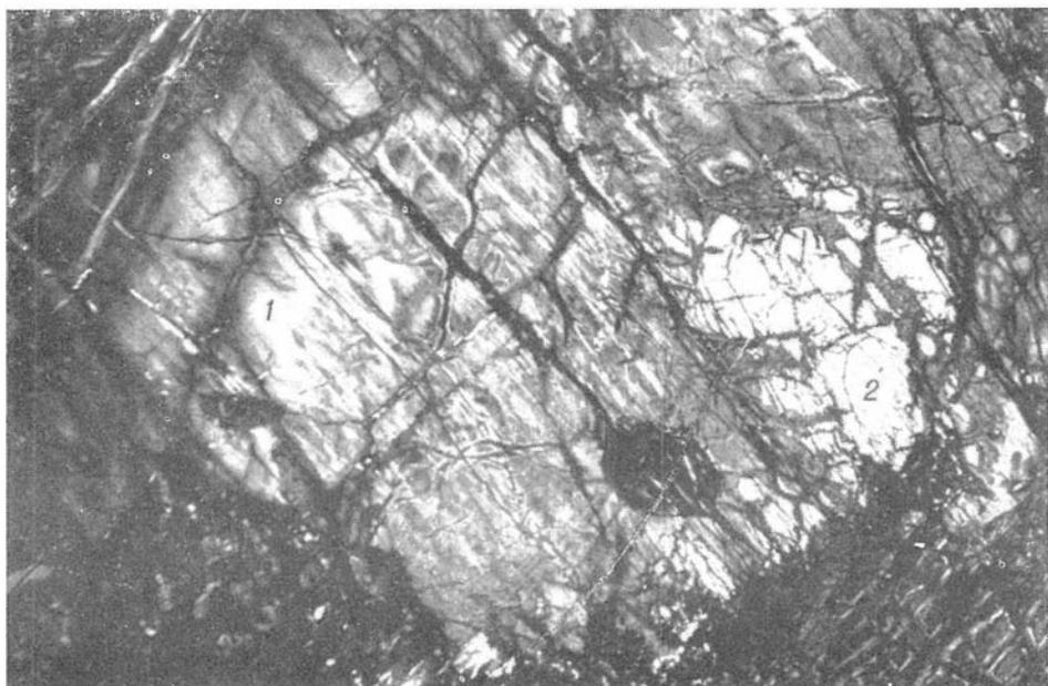
Табл. XXXI. Псевдоморфоза антигоритового бастита (1) по ромбическому пироксену (2). По баститу развиты более поздние жилки тонкопластинчатого антигорита. Шлиф 601 (Массив г. Длинной), с анализатором, увел. 34.
