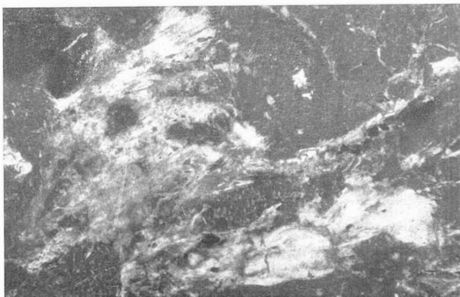
Табл. XXXIII. Замещение lizardite-антигоритового серпентинита волокнистыми «сноповидными» агрегатами хризотила (светлое). Шлиф 165<sup>Г</sup> (Пекульнейский массив), с анализатором, увел. 100.
