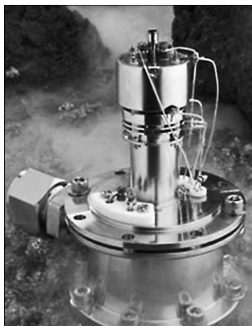
Рис. 18.5. Миниатюрный квадрупольный масс-спектрометр (линейные размеры 5 \times 5 \times 5 см; масса 2 кг)
