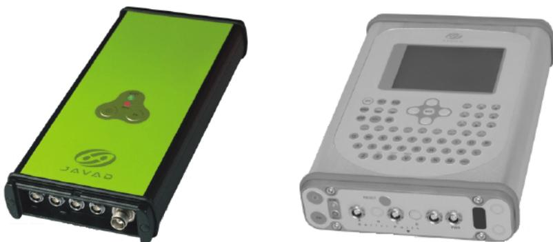
Рис. 5.18. Приемники компаний Javad - Topcon: Legacy-E GGD (Lexon-GGD), и Prego [<http://www.javad.com>].
