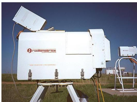
Рис. 6.10. Микроволновый радиометр паров воды корпорации Radiometrics [<http://radiometrics.com>].
