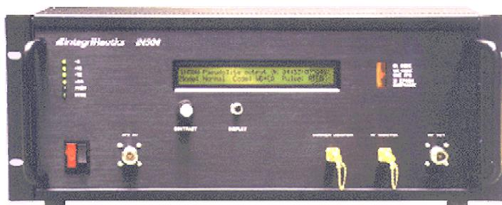
Рис. 4.24. Псевдоспутник IN500 фирмы IntegriNavics. [[www.integrinautics.com/technology/pseudolites.html](http://www.integrinautics.com/technology/pseudolites.html)].
