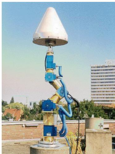
зависимыми изменениями фазового центра. В результате калибровки достигаются средние квадратические ошибки для смещений менее 1 мм. Было показано, что значительные изменения в параметрах антенны вызываются (1) непосредственной близостью к антенне антенн радиомодемной связи, (2) формой корпуса антенны, (3) деталями конструкции купола, (4) наличием отсекаателя [Schmitz et al., 2002].
