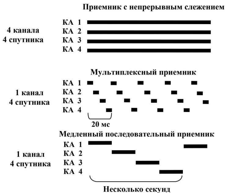
Рис. 4.20. Схемы слежения приемниками различного типа.
