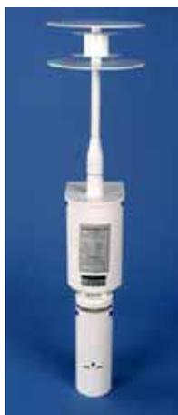
Рис. 6.9. Метеорологическая система Met3A компании Paroscientific. Точность измерения давления  $\pm 0.08$  ГПа в диапазоне 620 - 1100 ГПа. Точность измерения температуры  $\pm 0.1^\circ\text{C}$  от  $-50^\circ$  до  $+60^\circ$ . Точность измерения относительной влажности  $\pm 2\%$  в диапазоне от 0 до 100% при  $25^\circ\text{C}$  [<http://www.paroscientific.com>].
