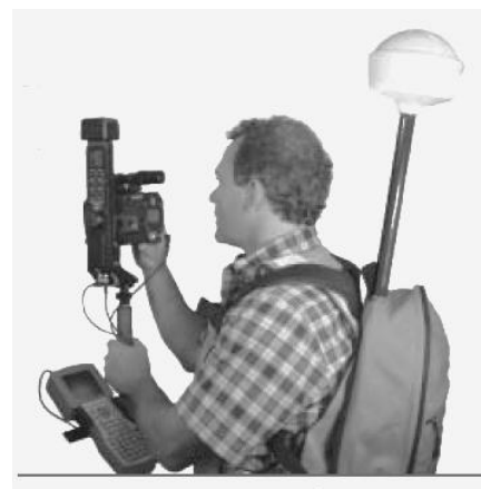
Рис. 8.13. Объединение лазерного импульсного дальномера, цифрового магнитного компаса и GPS приемника
