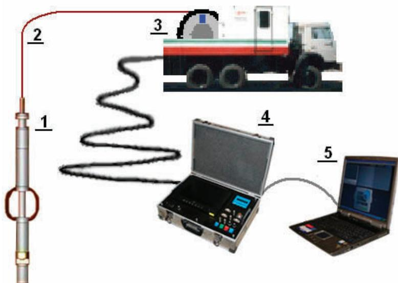
Рис. 4.12.1. Состав аппаратуры видеонаблюдений
