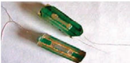
**Рис. 3.4.4. Кварцевый термочувствительный элемент**
