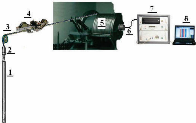
**Рис. 1.3.1. Комплект оборудования для проведения ГИС**
