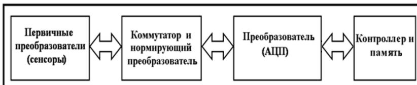
Рис. 2.1.1. Функциональная схема автономной скважинной аппаратуры
