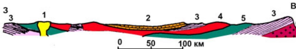
Рис. 21. Бушвельдский лополит 1 – сиениты, 2 – система Кару, 3 – трансваальская система, 4 – граниты, гранофиры, фельзиты, 5 – нориты, 6 – древние границы (по Г.Д.Ажгирею).
