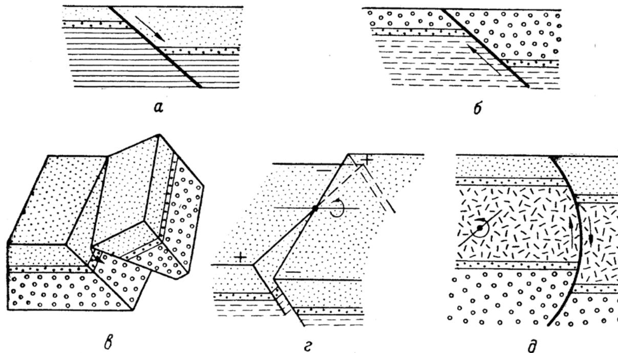
Рис. 13. Деление сбросов по направлению движения крыльев: *a* – прямой сброс, *б* – обратный, *в*, *г* – шарнирный, *д* – цилиндрический (*a*, *б*, *д* – вертикальные разрезы). Стрелки – направление движения крыльев
