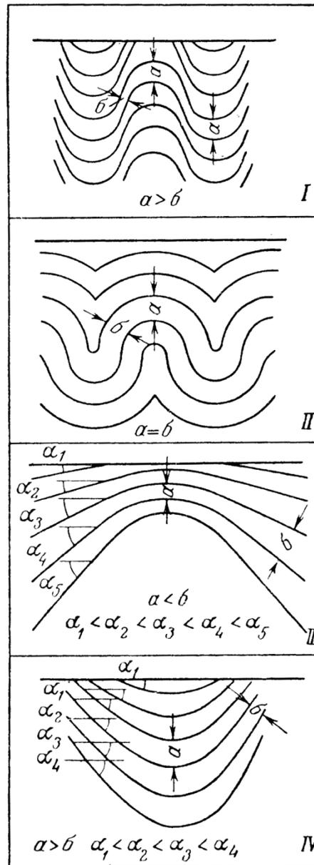
Рис. 12. Деление складок по соотношению мощностей на сводах и на крыльях: *I* – подобные, *II* – концентрические, *III* – с утоняющимися слоями в своде (изображены разрезы), *IV* – с повышенными мощностями пород в замках
