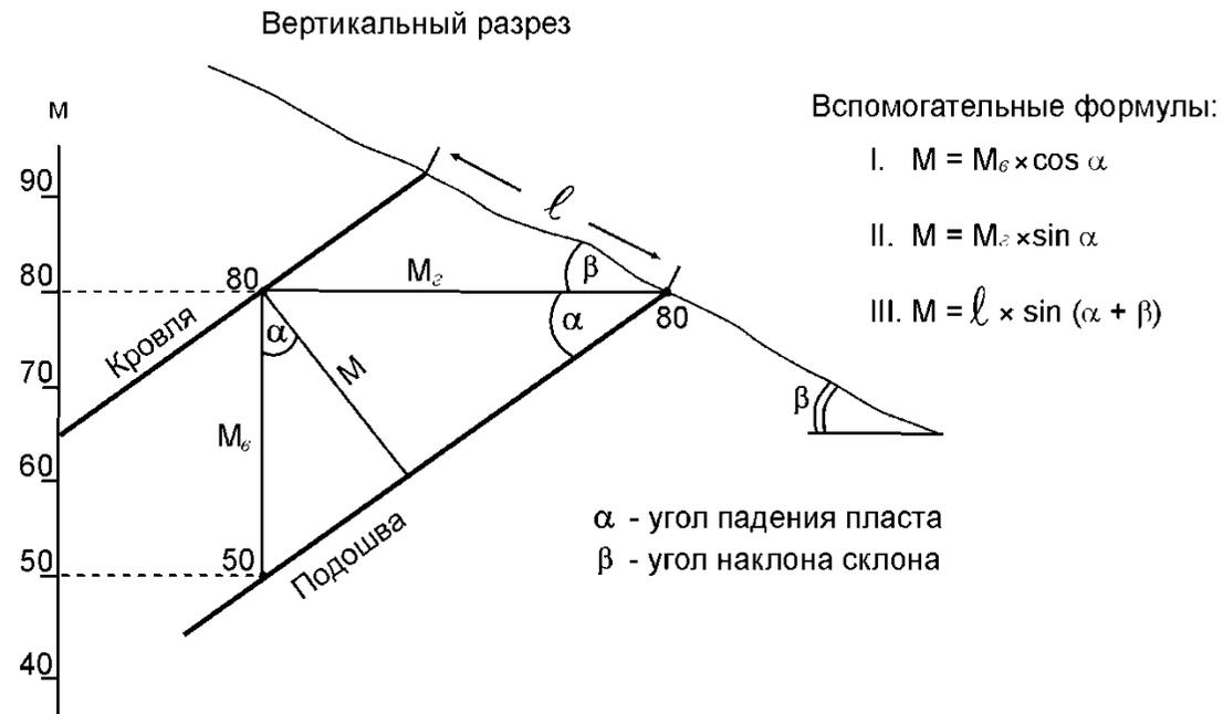
Рис. 1. Геометрия наклонного пласта и виды мощности,  $M$  – истинная,  $M_g$  – горизонтальная,  $M_v$  – вертикальная мощности пласта;  $l$  – видимая мощность (<http://www.studfiles.ru/preview/4244284/page:2/>).
