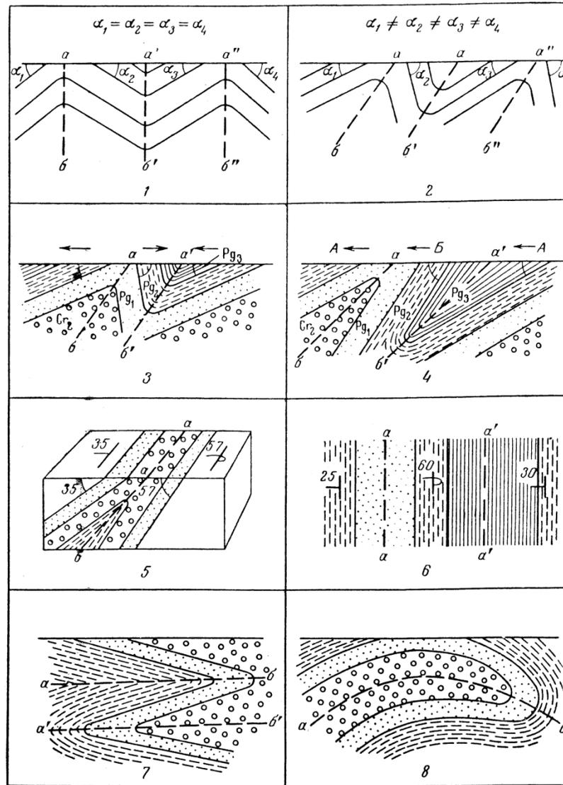
Рис. 9. Деление складок по положению осевой поверхности: 1 – симметричные, 2 – асимметричные, 3 – наклонные, 4 – опрокинутые – в вертикальном разрезе, 5 – опрокинутые – на блок-диаграмме, б – опрокинутые – в плане, 7 – лежащие, 8 – ныряющие (изображены разрезы);  $aa$ ,  $a'a'$  – осевые линии складок;  $аб$ ,  $a'b'$ ,  $a''б''$  – осевые поверхности складок
