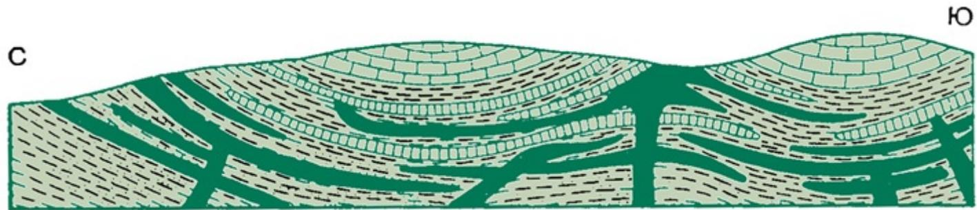
Рис. 27. Схема строения силлов.
