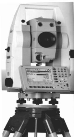
Рисунок 5.17 – Тахеометр LEICA TPS1200
