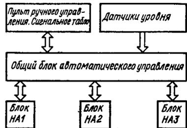
Рис. 13.9. Структурная схема системы управления шахтной водоотливной установкой
