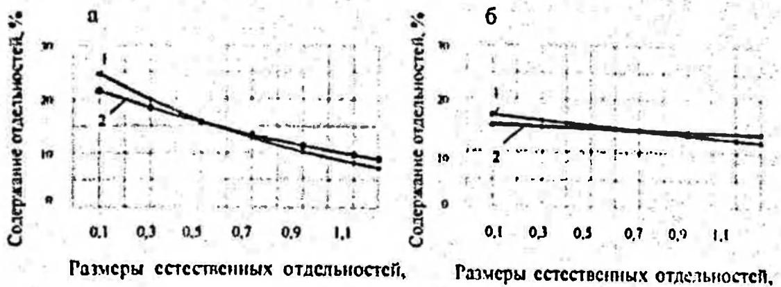
Рисунок 1.15 – Процентное содержание естественных отдельностей в крупноблочных (а) и весьма крупноблочных (б) массивах
