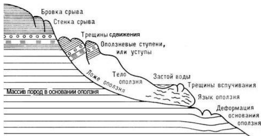
Рис. 19 Продольный разрез оползня (БСЭ с изменениями)
