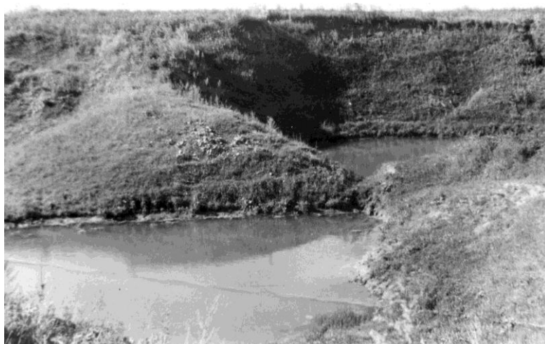
Рис. 22 Деформации земной поверхности в результате ведения подземных горных работ в районе г. Прокопьевск (Кузбасс) (РУЭ)
