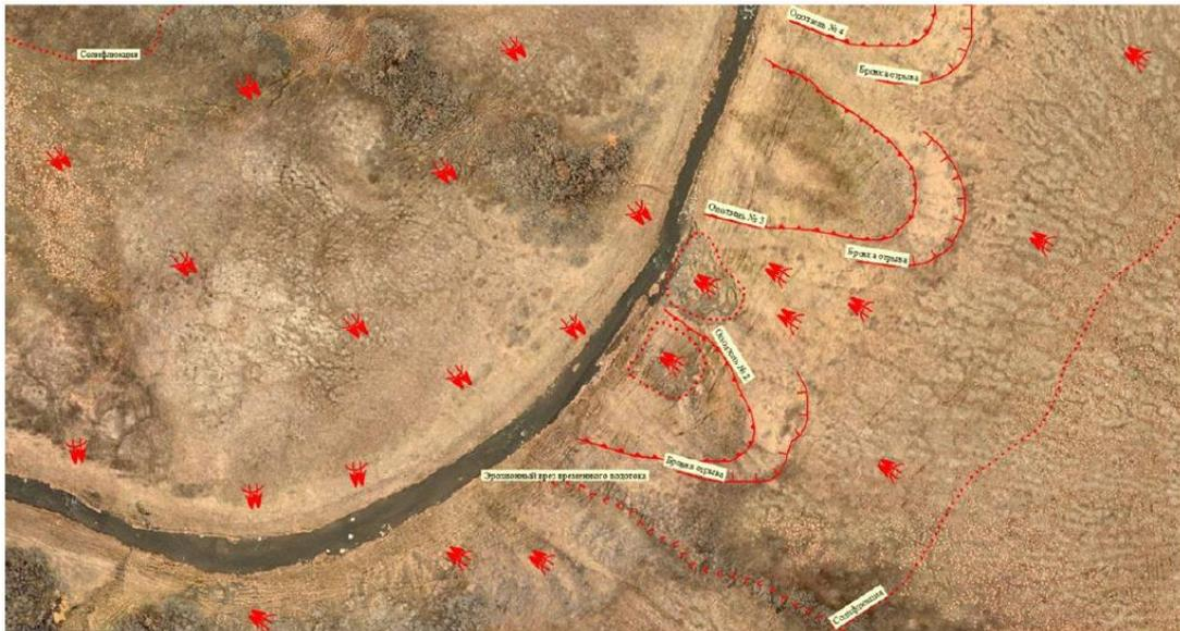
Рисунок 42. – Результаты дешифрирования аэрофотоснимка, «подгруженного» к цифровой модели рельефа (по автору, 2016) [55].
