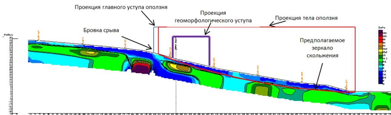
Рисунок 50. Разрез электротомографии сопряжённый с линией разреза 4-4 (по автору, 2019).
