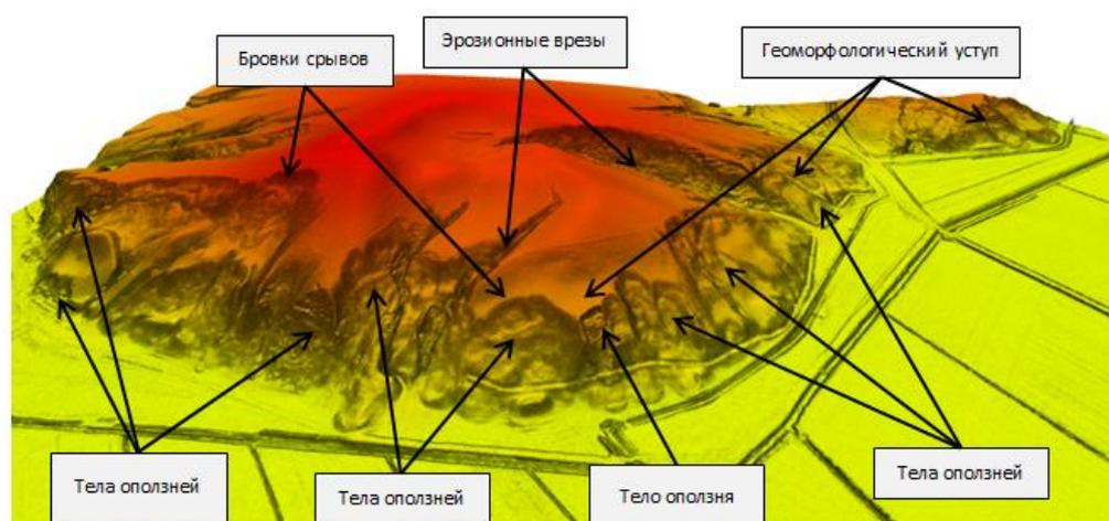
Рисунок 17. Цифровая модель рельефа с плотностью точек лазерных отражений от поверхности грунта до 10 на 1 м кв. и среднеквадратичной погрешностью 6 см. Выделение ОГП по первичным признакам (по автору, 2019).
