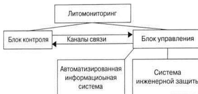
Рисунок 3. Структурная схема литомониторинга (по В. К. Епишину, В. Т. Трофимову, 1985).
