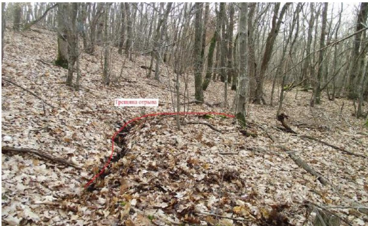
Рисунок 68. Трещина отрыва оползня в коридоре проектируемого трубопровода (по автору, 2014) [51].
