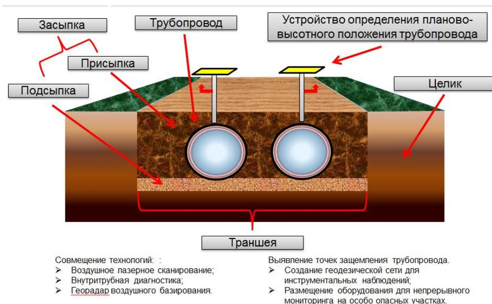
Рисунок 80. Использование устройства определения плано-высотного положения трубопровода (по Баборькину М.Ю. Бурцеву А.А., 2019) [39].
