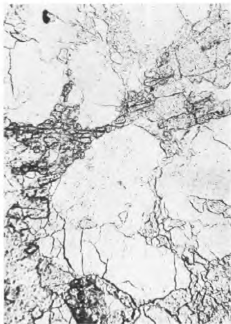
Фото 10. Включения диаспора (темно-серое) в андалузите (серое). Светлое — округлые (окатанные?) зерна кварца в кварците. Обр. 10131, КСГС, гл. 2277 м, с анализатором, \times 120
