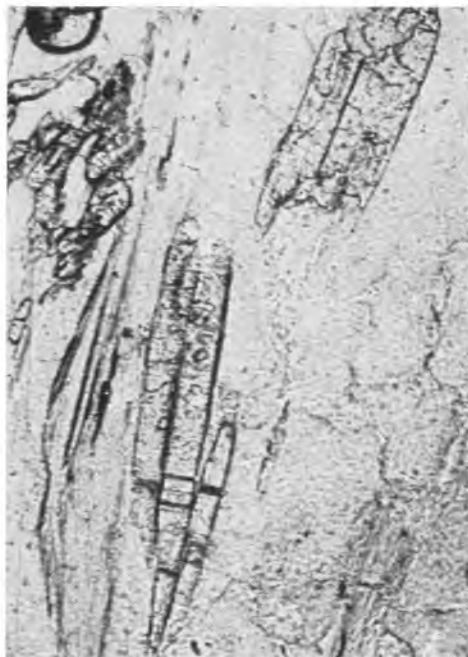
Фото 8. Призматические кристаллы дистена в кварците. Образец тот же, что и на фото 7, без анализатора, \times 140
