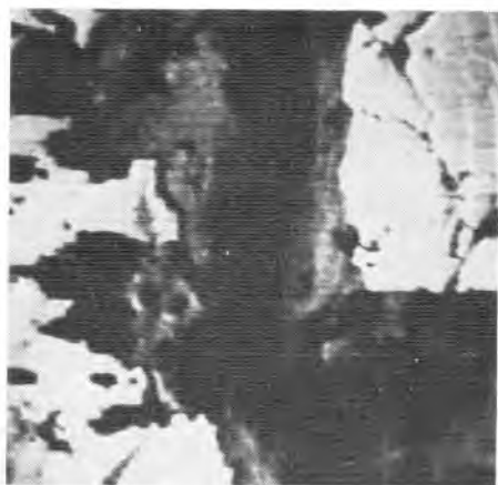
Фото 3. Разорванные сросшиеся индивиды граната. Светлое — гранат, серое — хлорит, черное — кварц. Жилка разрыва сложена кварцем и хлоритом. Видна коррозия граната (под электронным микроскопом), зерно то же, что и на фото 2, \times 150
