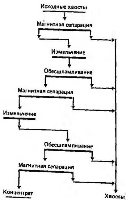
Рис. 4.5. Технологическая схема обогащения хвостов Северного комбината
