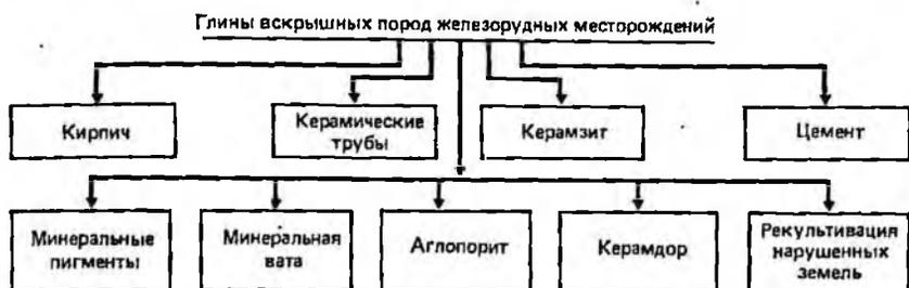
Рис. 3.1. Схема использования глины вскрышных пород для производства различных материалов
