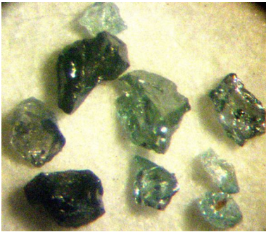
Рис. 5.63. Зерна муассанита с Уфимского плато. Фракция –1 мм
