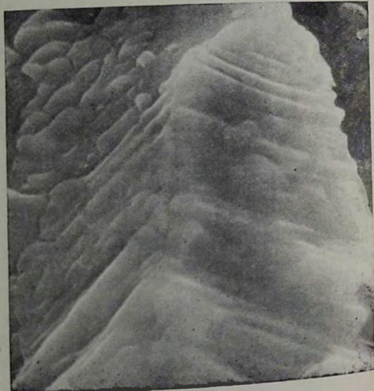
Рис. 29. Общий вид структуры силикагеля, отверженного хлористым кальцием
