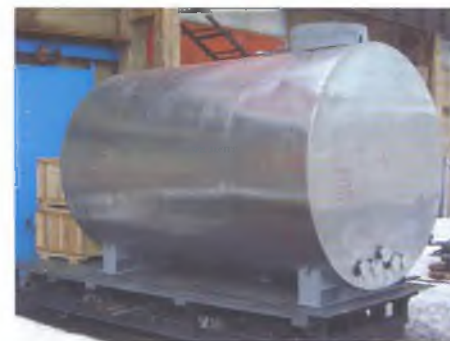
Резервуар с теплоизоляцией.
