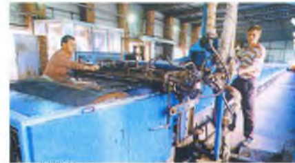
Линия по производству таблетированного лакового битума и готовая продукция.
