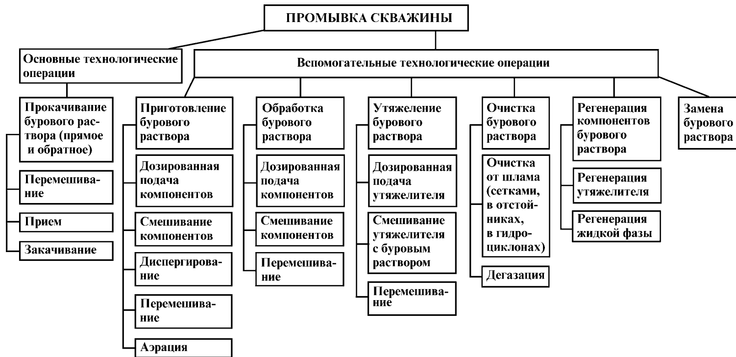
Рис. 6.2. Классификационная схема промывки скважины
