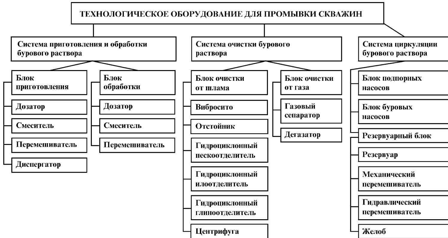
Рис. 6.3. Классификационная схема технологического оборудования для промывки скважины
