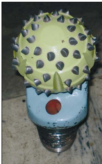
Рис. 34. Общий вид одношарошечного долота с открытой опорой
