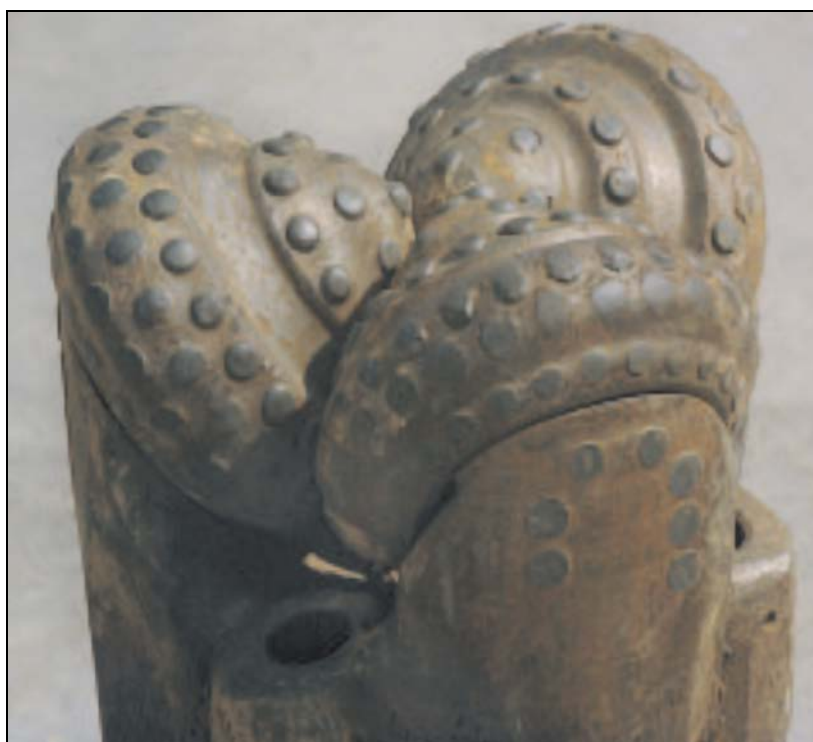
Рис. 40. Общий вид отработанного долота, описанного в примере 2
