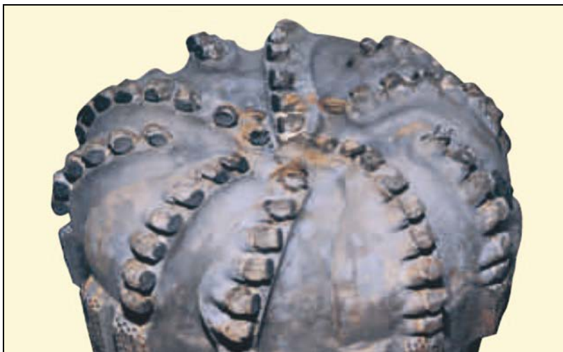
Рис. 68. Общий вид долота после четвертого спуска. Спецификация долота: тип R435SG; размер 12,25"; общая площадь потока 0,65–1,60 Таблица 11
