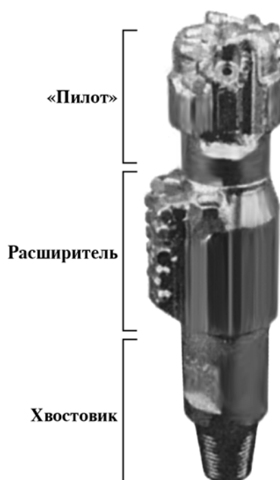
Рис. 54. Элементы бицентричного долота
