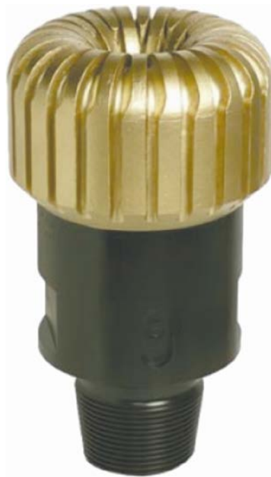
Рис. 43. Общий вид импрегнированного алмазного долота
