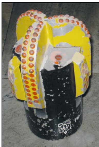
Рис. 44. Общий вид долота ИСМ радиального типа
