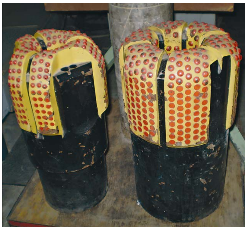
Рис. 72. Общий вид бурильных головок ИСМ
