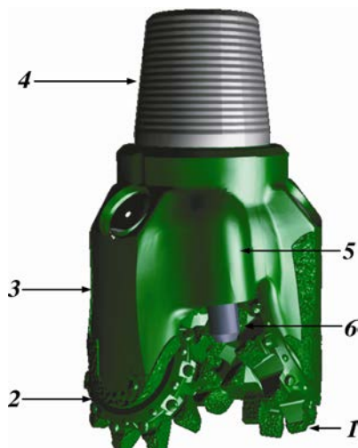
Рис. 4. Общий вид трехшарошечного долота: 1 – шарошка; 2 – козырек лапы; 3 – лапа; 4 – соединительная резьба; 5 – насадочный прилив; 6 – насадка
