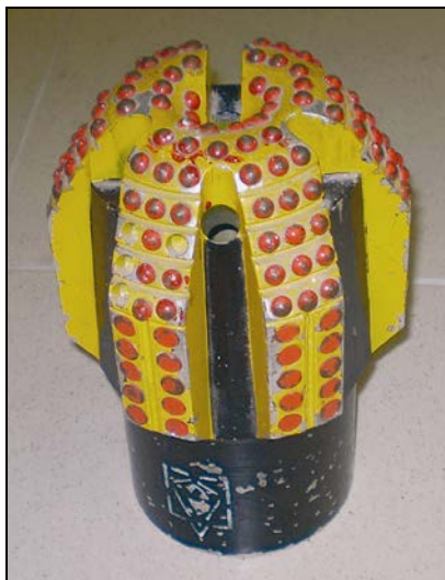
Рис. 46. Общий вид долота ИСМ секторного типа
