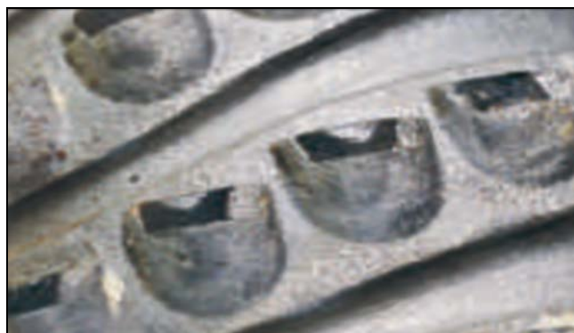
Рис. 62. Износ резцов (WT)
