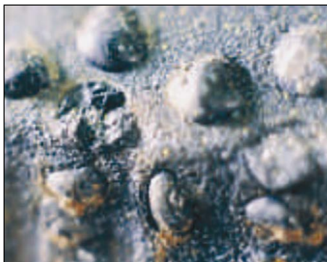
Рис. 63. Скол резцов (BT)
