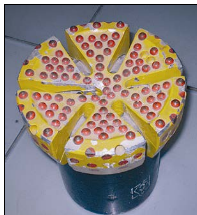
Рис. 45. Общий вид долота ИСМ торцового типа
