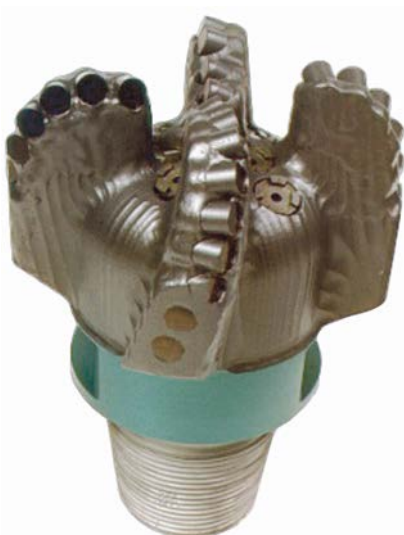
Рис. 51. Положение резца в лопасти долота PDC
