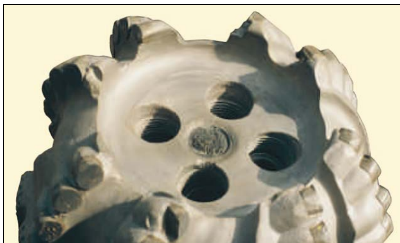
Рис. 67. Общий вид долота. Спецификация долота: тип R437GN; размер 8,5"; общая площадь потока 0,6
