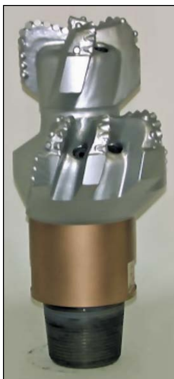
Рис. 53. Общий вид бицентричного долота
