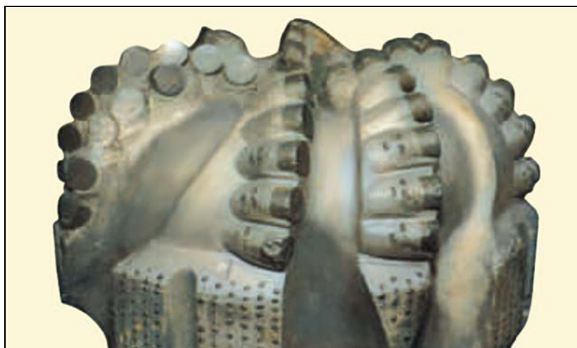
Рис. 66. Общий вид долота после подъема. Спецификация долота: тип R437GN; размер 8,5"; общая площадь потока 0,6
