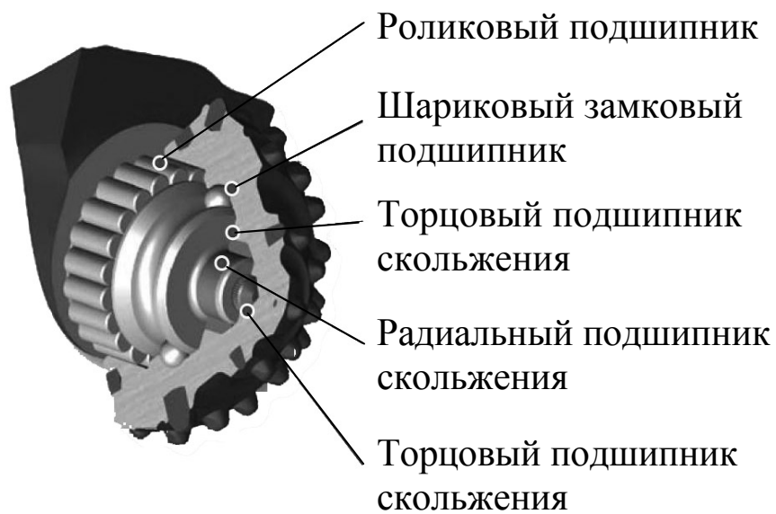
Рис. 3.21. Открытая опора типа Н
