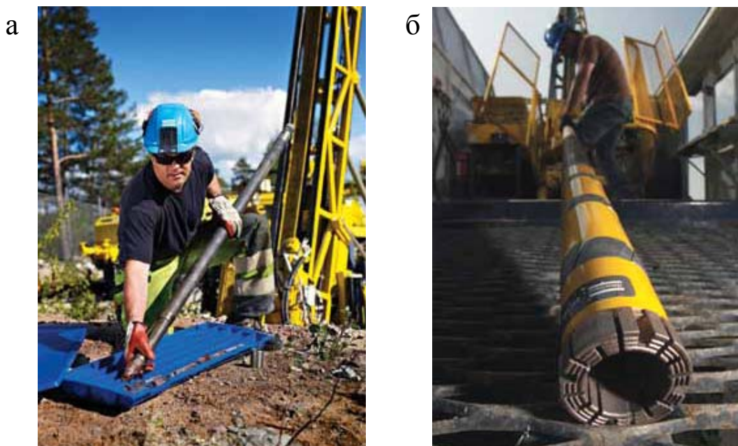
Рис. 3.44. Операции по извлечению кернов и демонтажу бурового става
