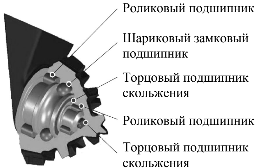
Рис. 3.22. Открытая опора типа В
