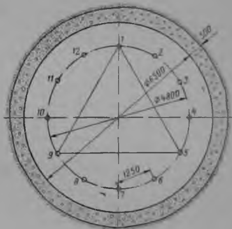
Рис. 6. Схема расположения скважин при цементации пород в стволе шахты «Вентиляционная» № 2
