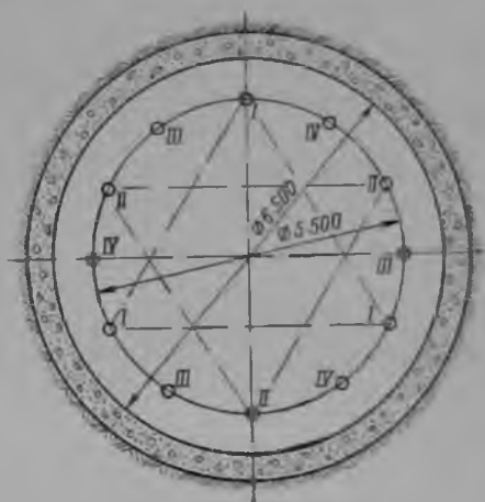
Рис. 5. Расположение скважин по схеме «треугольник»
