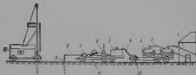
Рис. 54. Комплекс оборудования КЦ-10 для цементации горных пород с поверхности:
