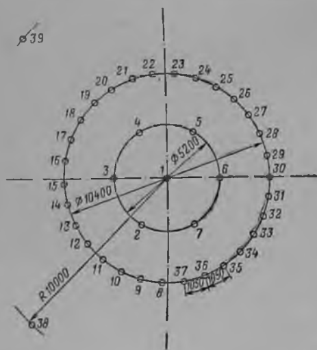
Рис. 13 Схема расположения скважин при цементации в стволе шахты лучевого водозабора
