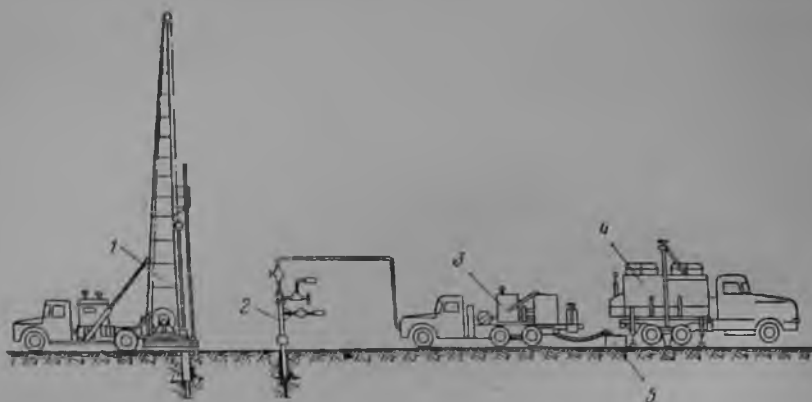
Рис. 52. Комплекс оборудования КЦП-1 для предварительной цементации с поверхности земли:
