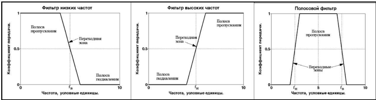
Рис. 4.1.1. Типы частотных фильтров.
