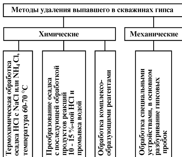
Рис. 9.23. Схема методов удаления выпавшего в скважинах гипса
