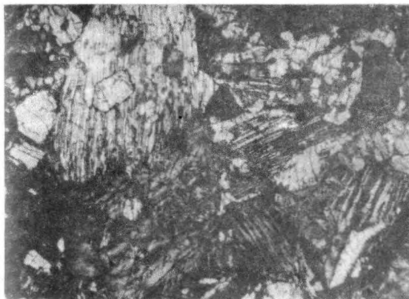
Рис. 4.5. Богатая пироксеном хондра в хондрите Маныч (LL3) с полисинтетически сдвойникованным клиноэнстатитом, который содержит кристаллы оливина и местами окружен пижонитом (белое). Николи скрещены. Ширина поля зрения 1,03 мм.
