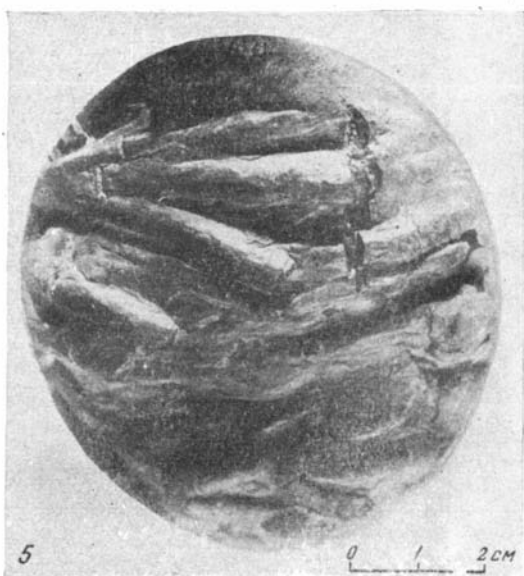
1. Конкреция магний сидеритового состава по кусту криноидей. Распиловка керна. 2. Тот же образец округлой поверхности керна. В центре минерализованных члеников криноидей — выделения пирита. 3. Округло-уплощенная конкреция с минерализованными члениками криноидей (черные). Распиловка керна. 4. Та же конкреция. Вид сверху. 5. Конкреция пиритово-магнийсидеритового состава по кусту криноидей. Вид сверху (торец керна).
