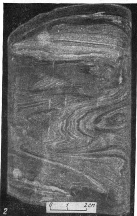
1. Песчаник тонкозернистый с очень тонкой горизонтальной прерывистой, слегка волнистой слоистостью, подчеркиваемой большим количеством мелкого растительного материала. Фация озер. 2. Алевролит крупнозернистый с интенсивно деформированной слоистостью. Вверху видна тонкая ненарушенная горизонтальная и мелковолнистая слоистость, подчеркиваемая мелким растительным материалом. Фация озер.
