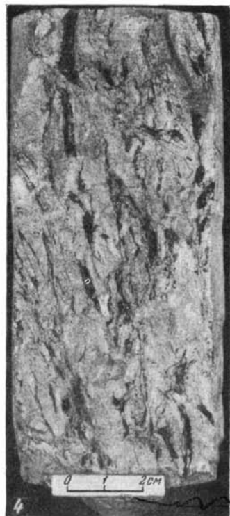
1. Песчаник разномзернистый с примесью гравия, с неясной косой слоистостью, подчеркиваемой грубыми обугленными растительными остатками. Видны зерна каолина. Фация русла. 2. Песчаник разномзернистый с гравием и галькой из алевролита и каолина, с обугленными растительными остатками. Фация русла. 3. Конгломерат. Фация временных потоков. 4. Алевролит крупнозернистый, светло-серый, неслоистый, с обильными корневыми остатками. Фация болот — «подпочва».
