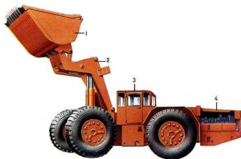
Рисунок 1.8. Ковшовая погрузочно-транспортная машина ПД-8: 1 - ковш; 2 - стрела; 3 – кабина управления; 4 – силовая установка
