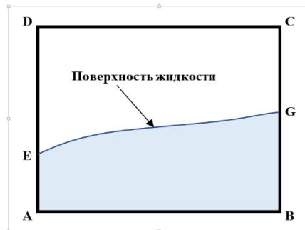
Рис.3.4. Схема элементарного блока пород в призме оползания
