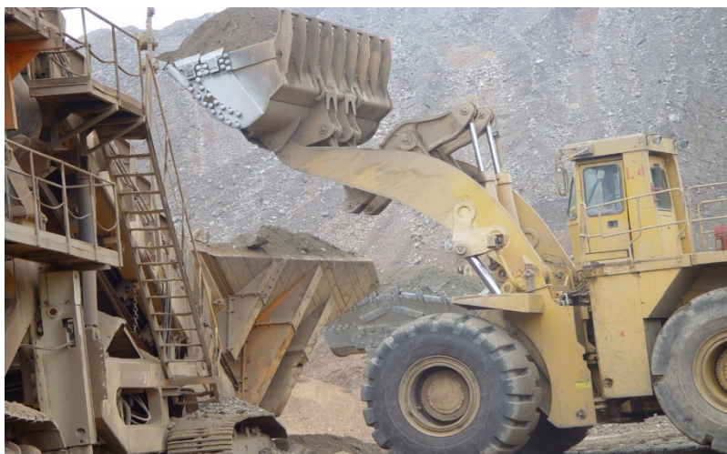
Рис. 2.9. Погрузка руды фронтальным погрузчиком в мобильный дробильно-перегрузочный пункт
