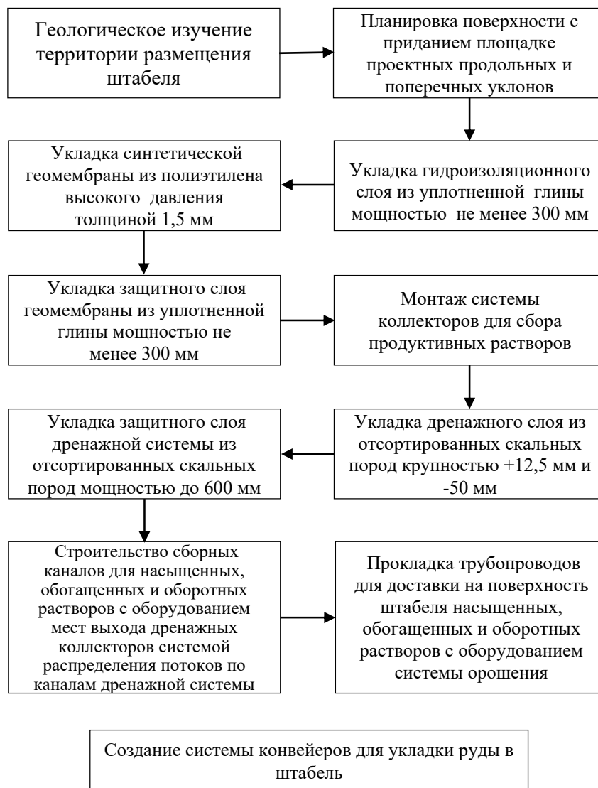
Рис. 2.5. Технологическая схема формирования подушки выщелачивания и дренажной системы
