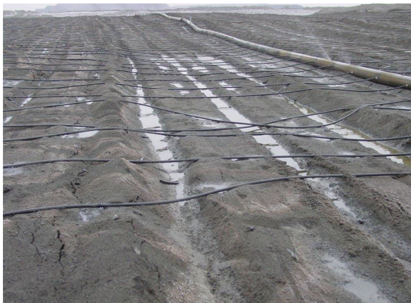
Рис. 5.16. Капельное орошение поверхности уложенной руды
