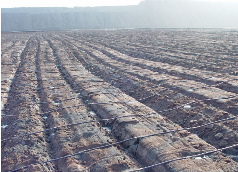
Рис. 2.6. Общий вид системы подачи растворов на поверхность штабеля
