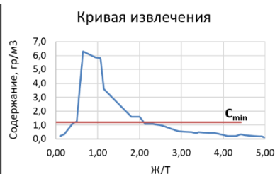
Рис. 2.16. Изменение степени извлечения (а) и концентрации (б) золота в растворе в процессе выщелачивания:
