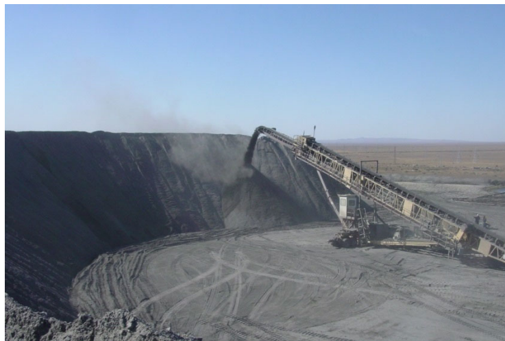
Система мобильных конвейеров для доставки руды на нижний ярус штабеля подушки выщелачивания
