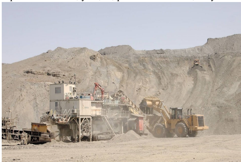
Рис. 5.4. Загрузка руды в приемный бункер передвижного пластинчатого питателя фронтальным погрузчиком
