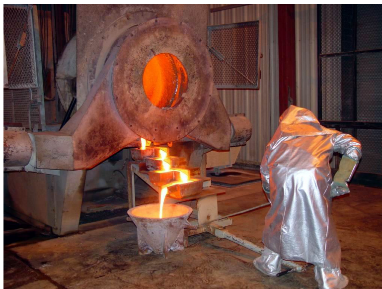
Разлив плава в тигле из электродуговой печи
