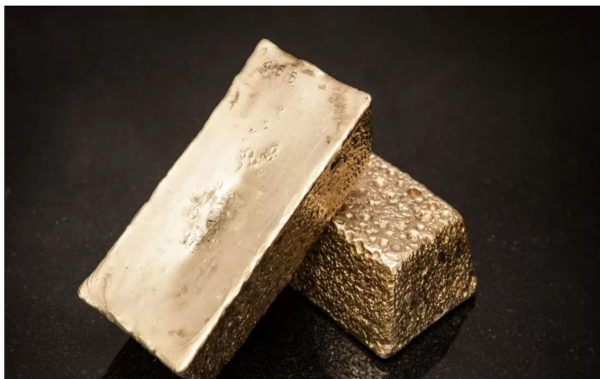
Сплав Доре - готовая продукция цеха кучного выщелачивания золота
