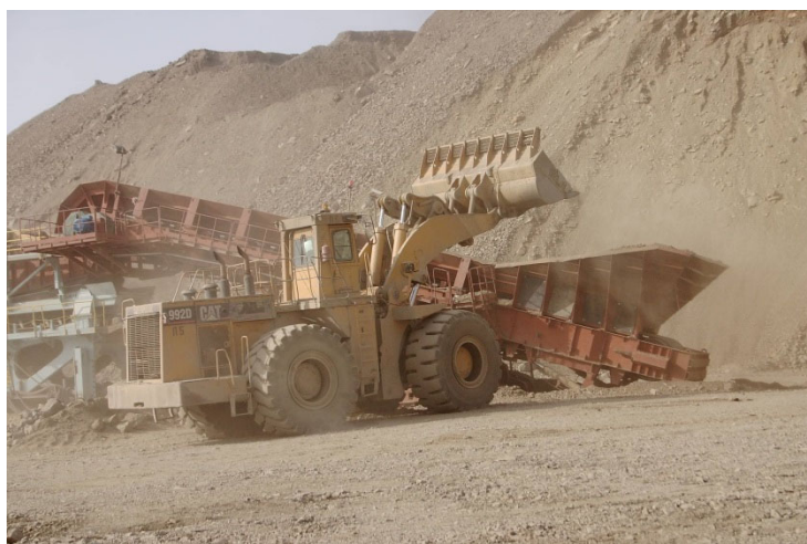
Подача руды погрузки в приёмный бункер дробильно-сортировочного комплекса
