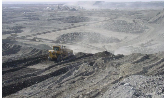
Рис. 5.3. Отработка уступа бульдозером. Внизу по горизонту складированы негабаритные куски
