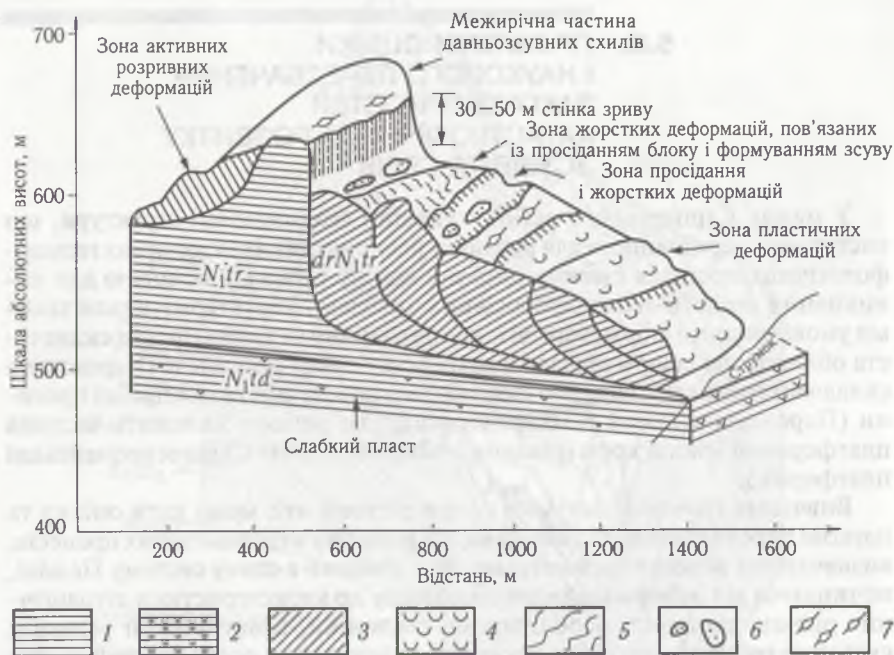
Мал. 33. Принципова схема формування й розвитку структурно-пластичного зсуву «Вільхівчик», активізація якого відбулася в листопаді 1998 р.:
