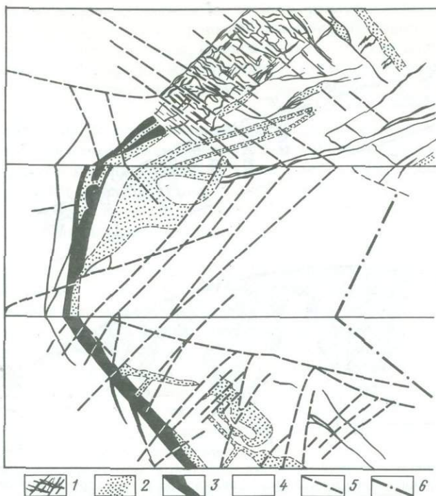
Р и с. 10. Зависимость морфологии жильной зоны от трещиноватости; развертка стенок и кровли выработки
