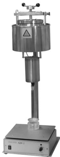
Рис. 2.13. Общий вид аппарата для определения остаточной водонасыщенности керна АДЖ-2
