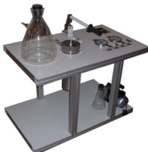
Рис. 2.2. Установка для насыщения образцов керна УНК-11
