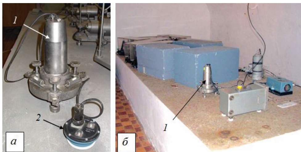
Рис. 7.20. а) наклономер НМД-Ш (1) с устройством согласования (2) и его расположение на постаменте сейсмической станции МНВ ГФО «Михнево» (б)
