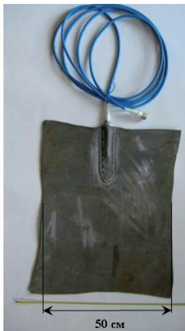
Рис. 4.15. Свинцовый электрод для регистрации градиента потенциала в грунте
