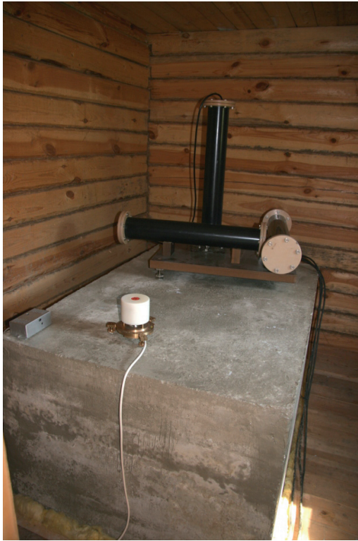
Рис. 5.9. Внутренний вид магнитного павильона с магнитометром LEMI-018
