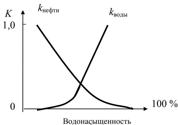
Рис. 1.3. Относительная проницаемость песка для нефти и воды
