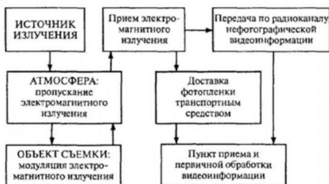
Рис. 1.1. Схема получения первичных данных дистанционного зондирования
