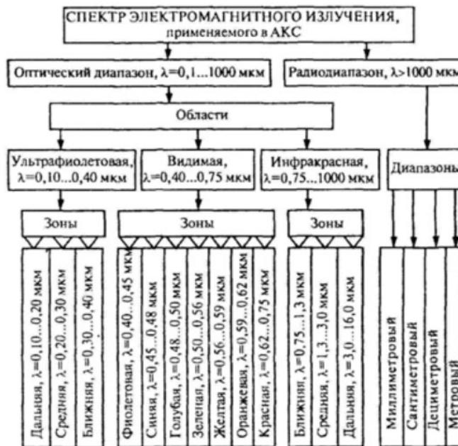
Рис. 1.2. Схема деления спектра электромагнитного излучения, применяемого при производстве аэро- и космических съемок
