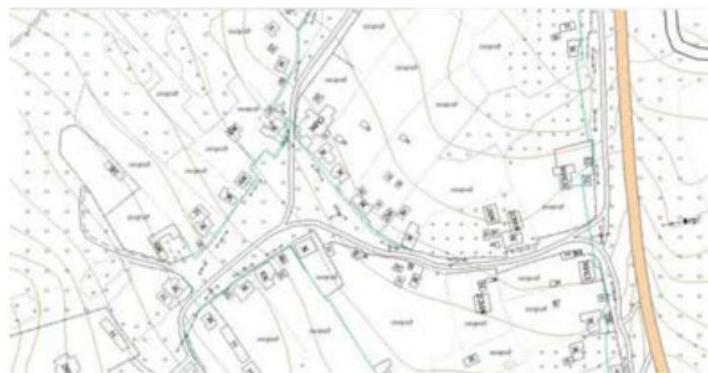
Рис. 14.3. Топографический план, созданный по снимкам, полученным с БПЛА
