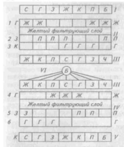
*Рис. 4.6. Схема получения цветного изображения:*
