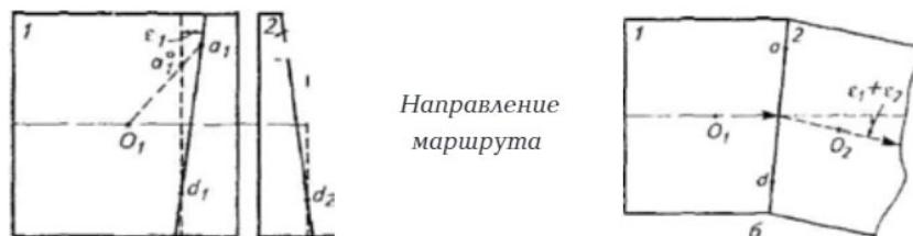
Рис. 8.9. Искривление фотосхемы рельефной местности
