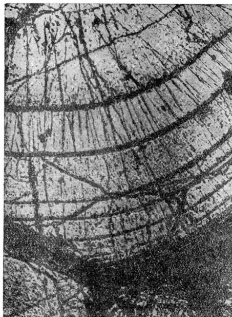
Рис. 7. Концентрические зоны настурана с различной отражательной способностью. Аншлиф. \times 17 (по А. А. Кругловой)
