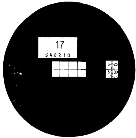
Рис. 137. Поле зрения отсчетного микроскопа теодолита Т2
