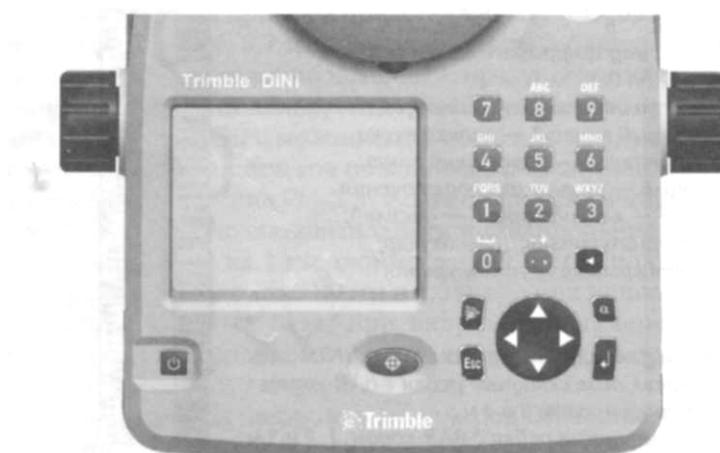
Рис. 120. Клавиатура и дисплей панели управления DiNi 0.3/0.7
