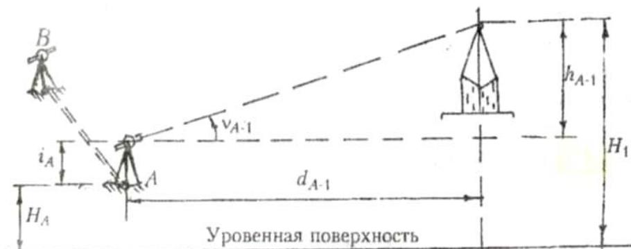
Рис. 83. Схема передачи отметки с опорной на пространственную точку
