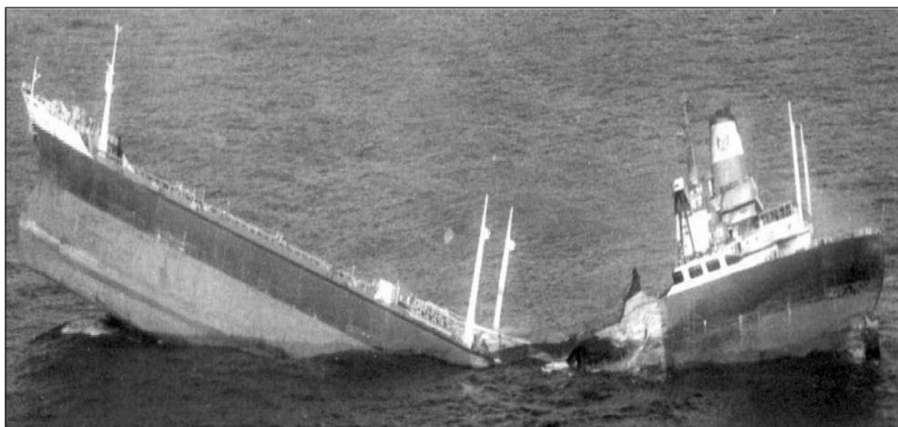
**Рис. 5.8.** Фотографии разрушений кораблей после встречи с волнами-убийцами
