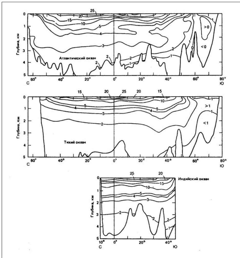
Рис. 2.12. Изменение температуры по вертикали в трех океанических бассейнах [Dietrich, 1963]
