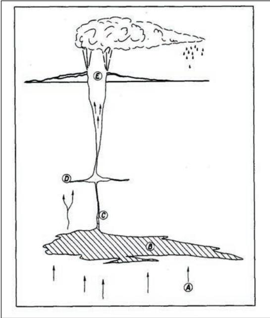
**Рис. 3.18.** Схема строения вулканической системы по Мак-Гетчину, на которой показаны диффузия летучих (A), место образования магм (B), дайкообразная проводящая магматическая камера (C), промежуточная камера (D) и взрывной кратер (E) [Йодер, 1979]
