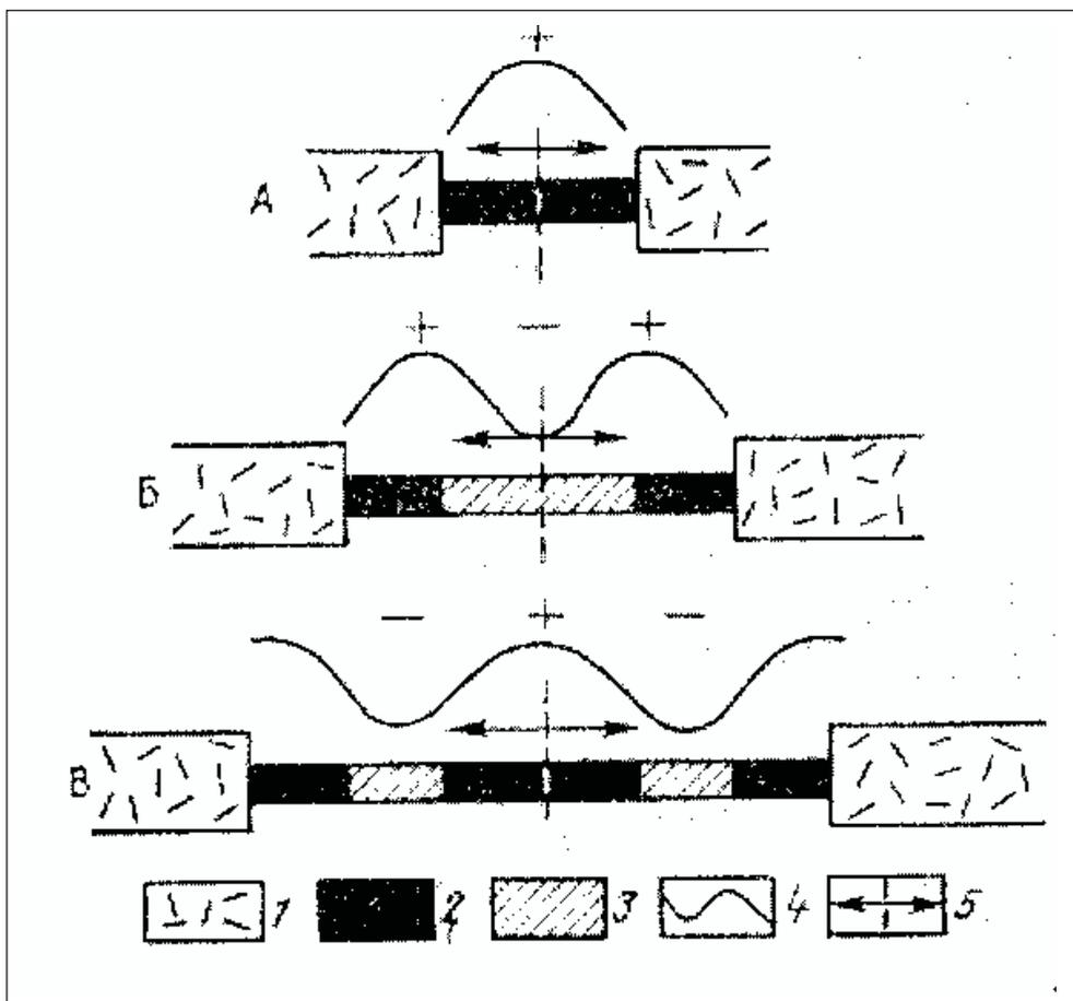
**Рис. 3.3.** Схема, поясняющая образование знакопеременных линейных магнитных аномалий океана по гипотезе Вайна — Мэтьюза [Новая глобальная..., 1974]: А—В — последовательные стадии раскрытия рифта и формирования океанической коры; 1 — континентальная кора; 2 — кора, образованная в эпоху нормального магнитного поля; 3 — то же в эпоху обращенного магнитного поля; 4 — кривая магнитных аномалий; 5 — ось спрединга
