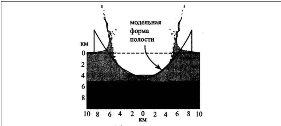
**Рис. 5.5.** Форма полости, образующейся в воде при падении метеорита: сопоставление результатов численного моделирования [Crawford and Mader, 1998] и идеализированной модели [Ward and Asphaug, 2000]. Расчет выполнен для момента времени 25 с при диаметре астероида 500 м, скорости падения 20 км/с, плотности 3,32 г/см<sup>3</sup>, глубине океана 5 км
