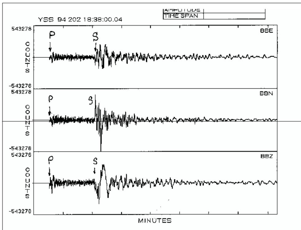
**Рис. 3.10.** Сейсмограмма землетрясения, записанная сейсмостанцией «Айрис-2» в г. Южно-Сахалинске 21 июля 1994 г. в 18 час. 38 мин. 00 сек.: P — вступления продольных волн, S — поперечных [Злобин, 2006]
