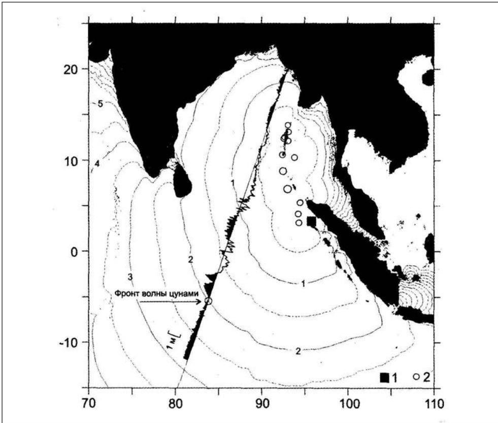
**Рис. 5.2.** Карта северо-восточной части Индийского океана с изохронами, показывающими расчетное положение фронта цунами 24 декабря 2004 г. с интервалом 0,5 часа [Куликов и др., 2005]: 1 – эпицентр главного землетрясения; 2 – эпицентры основных афтершоков. Трасса спутника JASON-1 (виток 109–129) и вдоль нее – профиль уровня океана по данным альтиметрии
