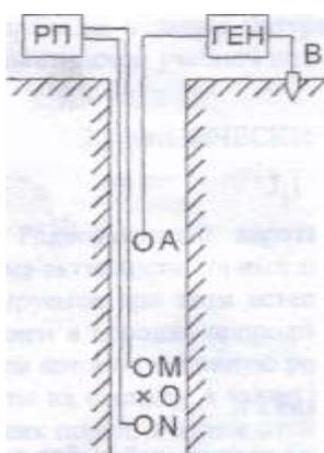
Рис. 1.1. Схема проведения каротажа сопротивления (КС)
