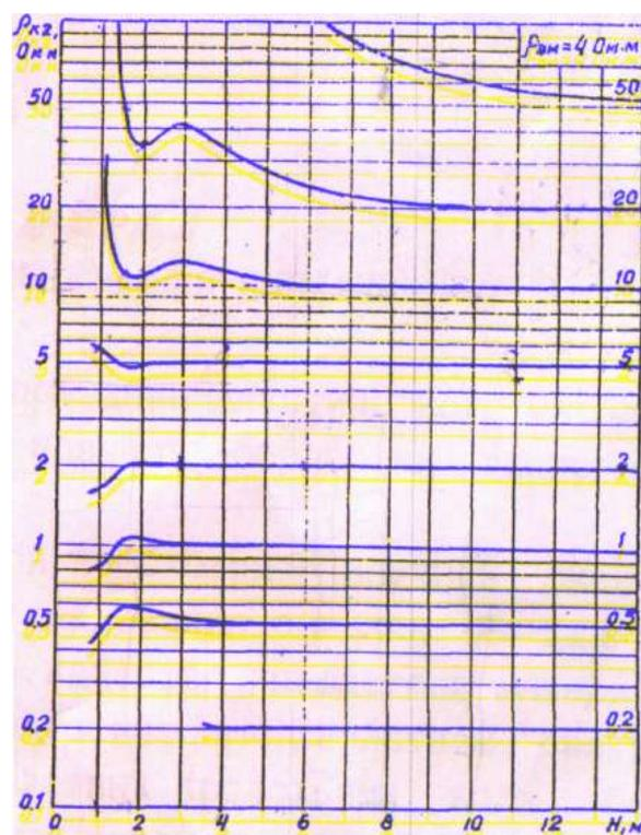
Рис. 4.3. Палетки для введения поправки за влияние вмещающих пород и мощности пласта в показания зонда 6Ф1.
