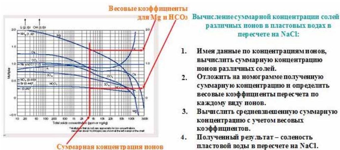
Рис. 29. Схема пересчета концентраций солей в эквивалентное содержание NaCl
