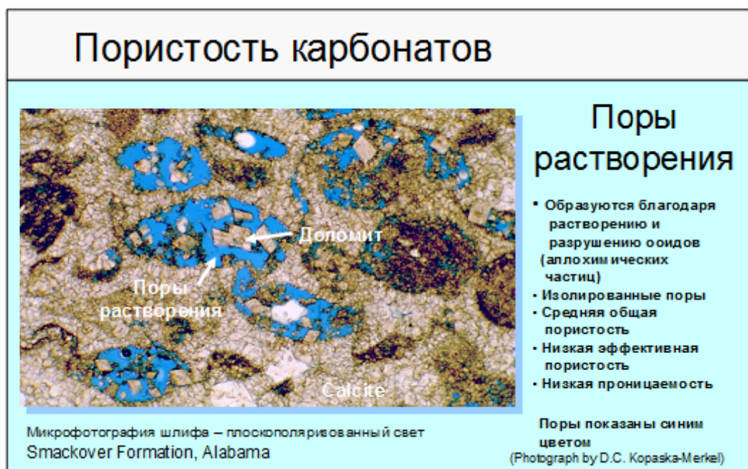
Рис. 3. Структура карбонатной горной породы
