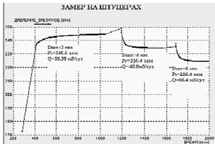
Рис. 92. Замер на штуцерах
