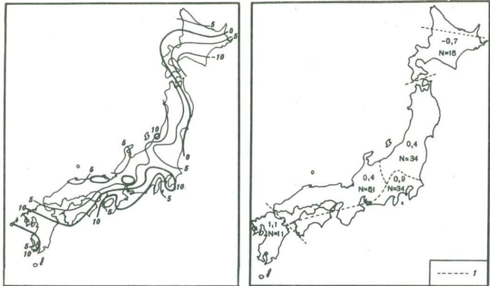
Рис. 15. Сглаженные изолинии невязок ( $0\text{--}Ch$ ,  $0,1$  сек) времен пробега  $P$ -волн для ядерного взрыва Кэникин, произведенного в 1971 г. на о-ве Амчитка, в центральной части Алеутских островов
