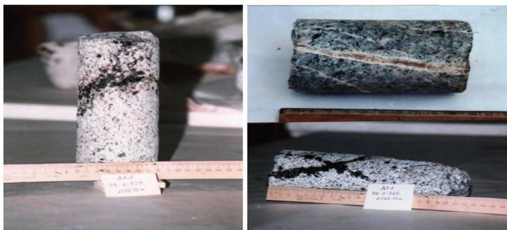
Рис. 4.5 – Нефтенасыщенный керн из пород фундамента месторождения Дайхунг на шельфе Южного Вьетнама
