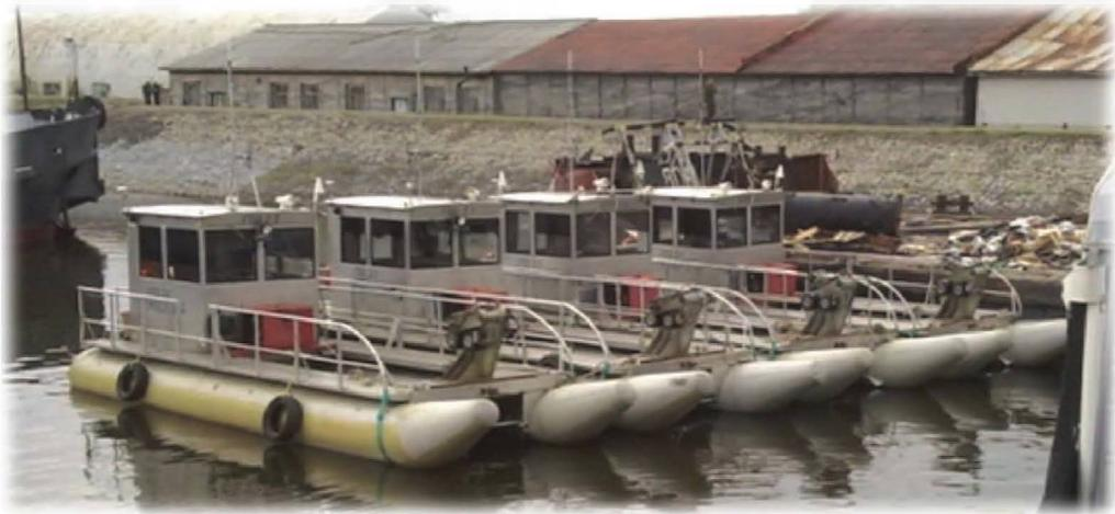
Рис. 1.29 – Катамараны – раскладчики сейсмических кос, оборудованные приемниками GPS и необходимым спускоподъемным оборудованием
