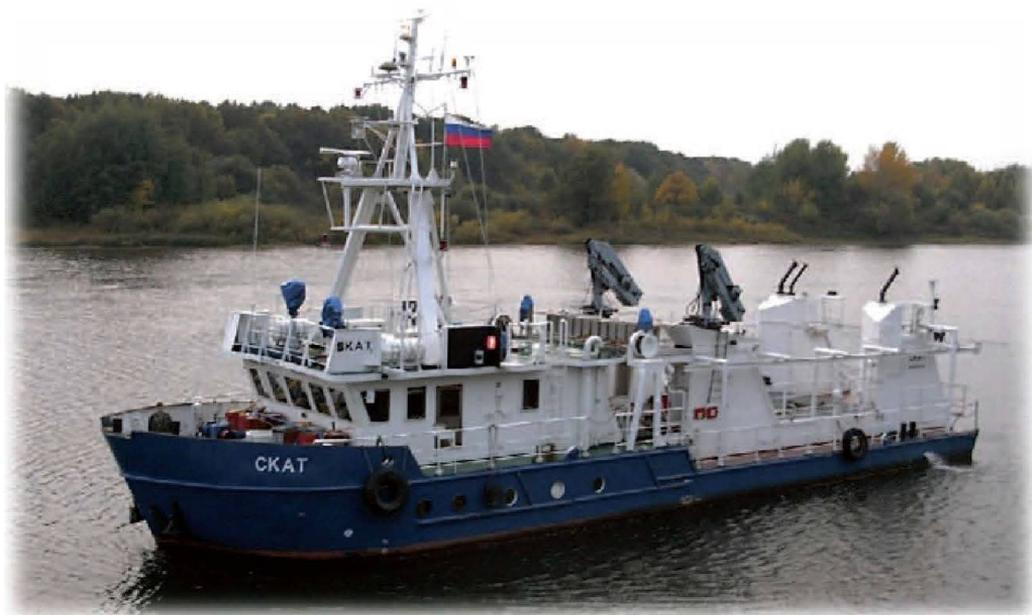
Рис. 1.30 – Судно для производства работ в мелководных транзитных зонах до глубин менее 2,5 метров
