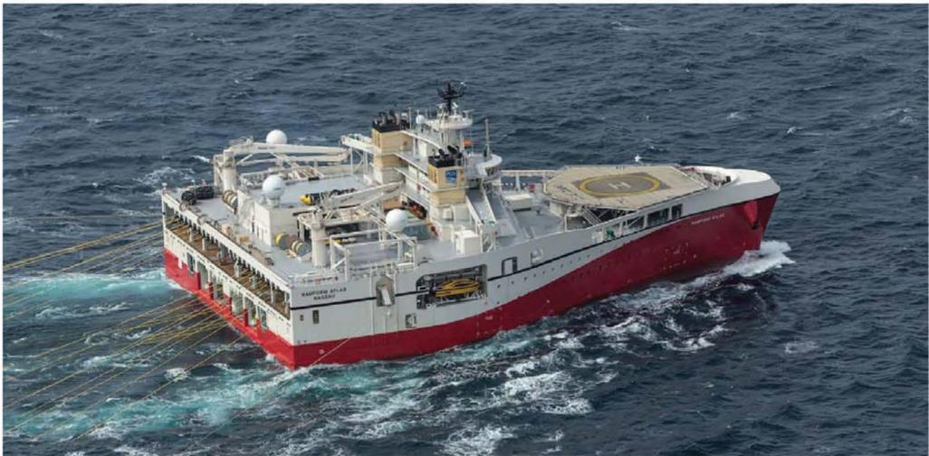
Рис. 1.7 – Производство морских сейсморазведочных работ 3D с 12-ю косами. Ramform Titan (PGS)
