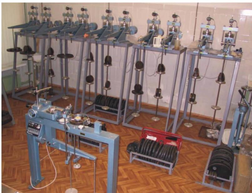
Рис. 6.12 – Сдвиговой (WF) и компрессионные приборы
