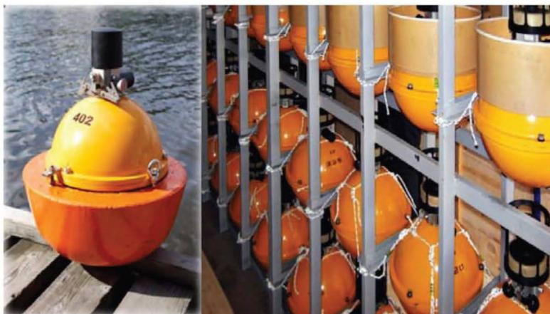
Рис. 1.41 – Четырехкомпонентные донные станции
