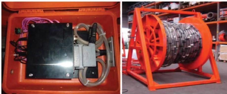
Рис. 6.20 – Сейсмостанция (слева) и многоканальная аналоговая пьезокода (справа)
