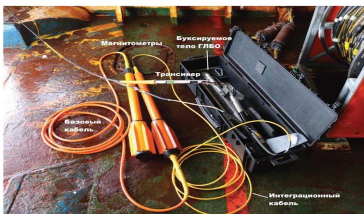
Рис. 6.26 – Буксируемые тела (магнитометры + ГЛБО) перед спуском
