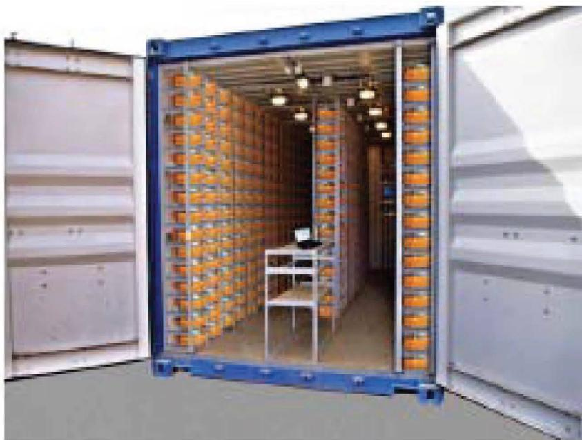
Рис. 1.11 – Комплекс сейсмических донных станций «Turtle» на базе компьютеризованного контейнера
