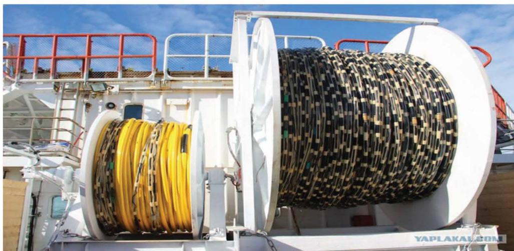
Рис. 1.17 – Сейсмическая коса на борту научно-исследовательского судна
