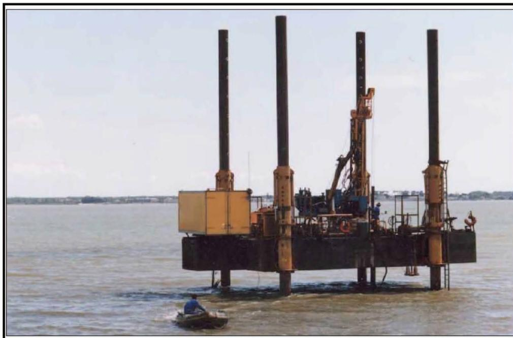
Рис. 6.8 – Самоподъемная платформа малых размеров для работы в транзитных мелководных зонах
