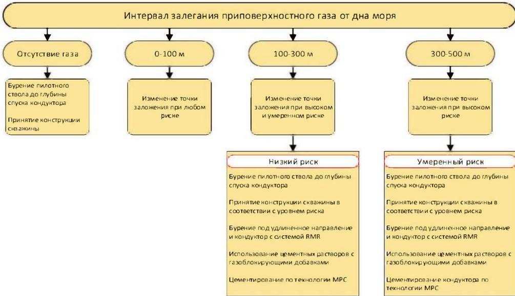
Рис. 6.39 – Матрица принятия решений в условиях потенциальных проявлений мелкозалегającego газа при бурении с полупогружной плавучей буровой установки
