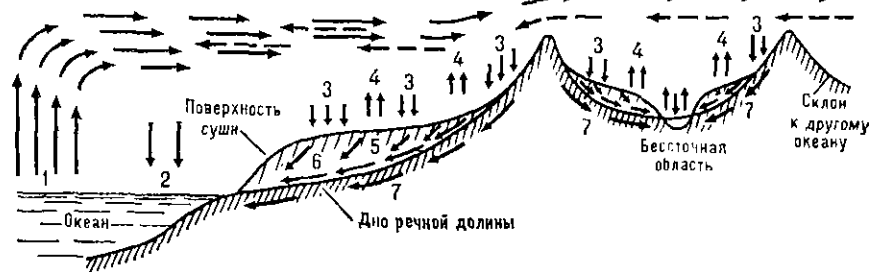
Схема влагооборота воды в природе: 1 — испарение с поверхности океана; 2 — выпадение осадков на поверхность океана; 3 — выпадение осадков на поверхность суши; 4 — испарение с поверхности суши; 5 — испарение в подзёмный сток в реки; 6 — речной сток в океан; 7 — подзёмный сток в океан или в бессточную область.
